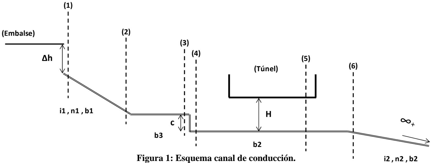
**Figura 1: Esquema canal de conducción.**
