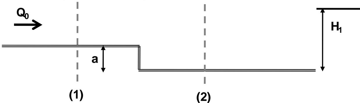
i) ¿Qué condición(es) debe(n) cumplirse para que el flujo sea subcrítico en todo el canal? ¿Como se calculan las alturas de escurrimiento en las secciones (1) y (2) en ese caso?
