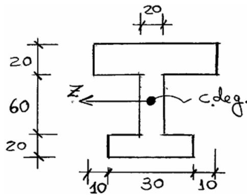
P2.- Calcule el máximo esfuerzo de compresión en la viga del esquema.
