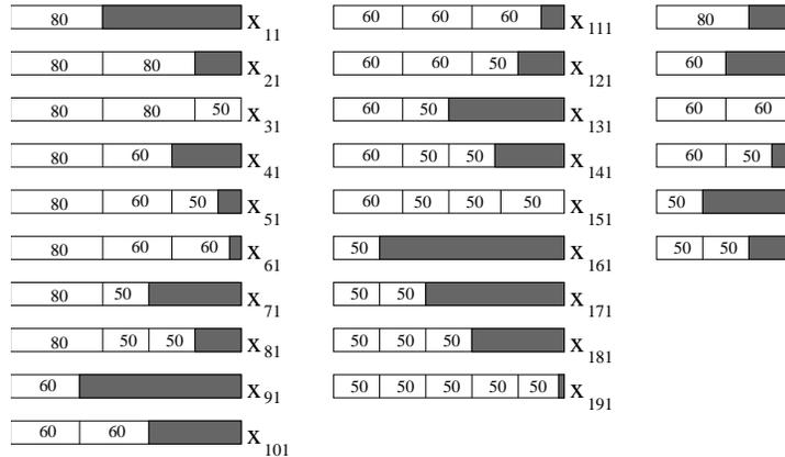
Figura 3.3: Posibles configuraciones de corte
