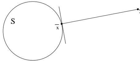
Figura 2.11: La proyección de  $y$  sobre  $S$  se alcanza en un punto  $\bar{x}$  tal que el trazo  $y - \bar{x}$  es ortogonal al conjunto.
