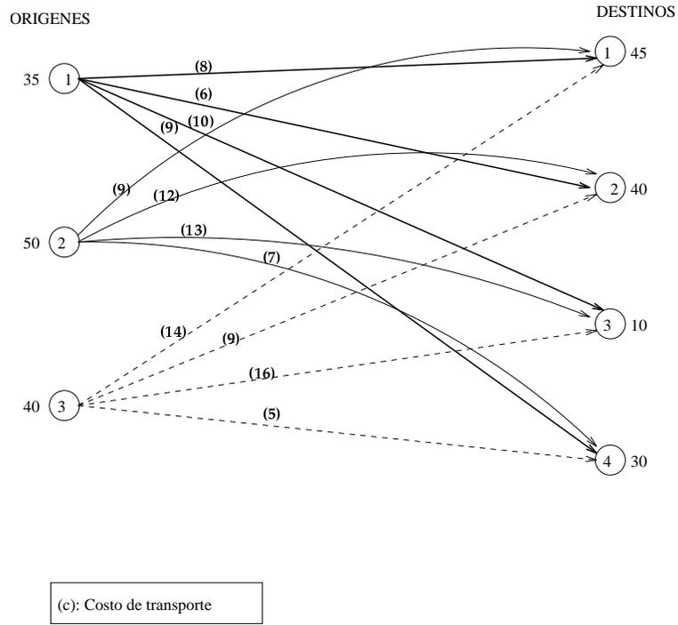
Figura 4.8: Procedimiento de saturación a costo mínimo
