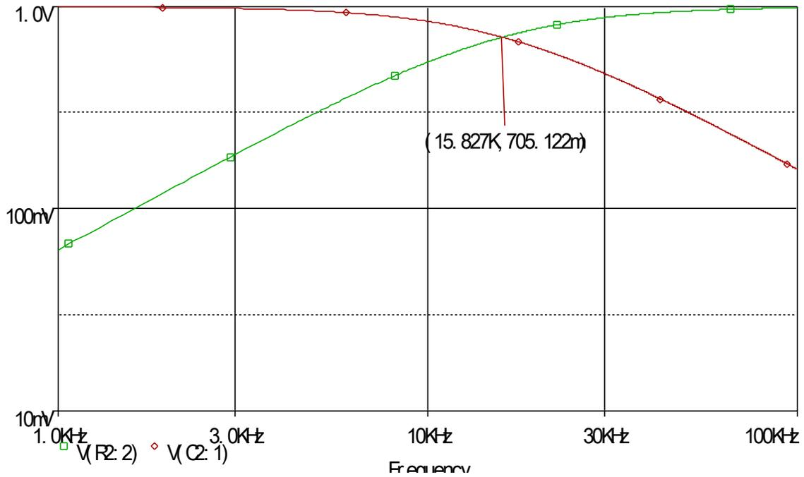
Se ve que en la intersección de ambas curvas se tiene una amplitud cercana a la requerida para la frecuencia de corte. Esto se podría obtener analíticamente igualando ambas funciones de transferencia.
