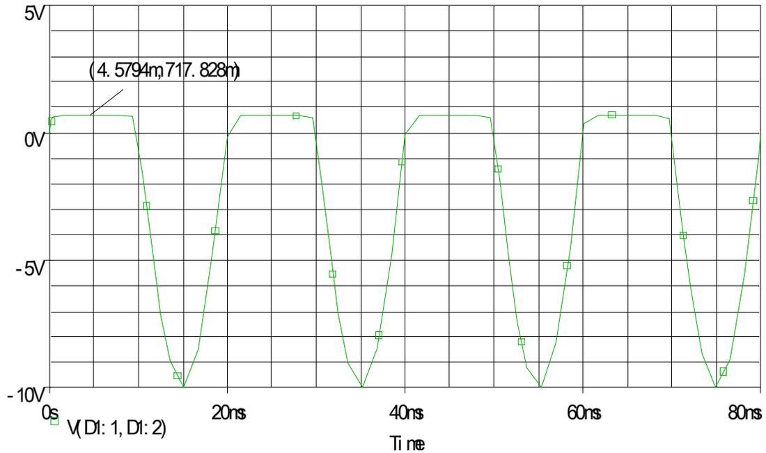
Se tiene que para este diodo en particular, la caída es de 0,717828 [V]. Que es un valor muy común en diodos de silicio.
