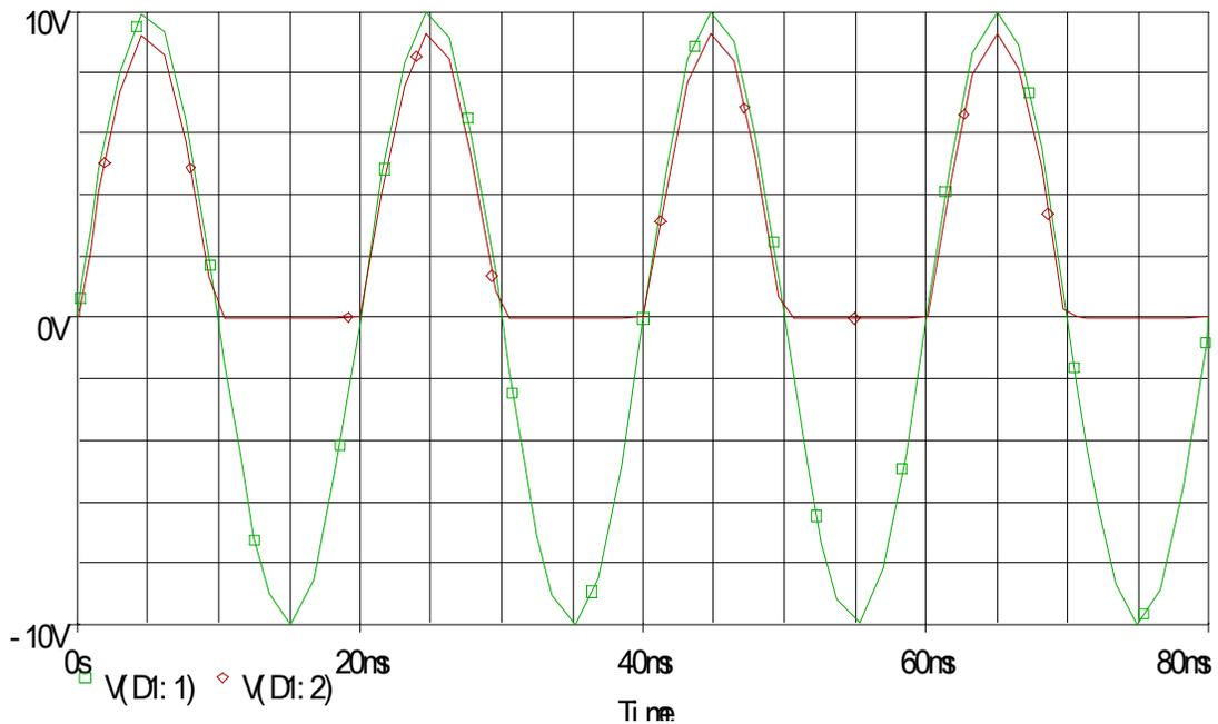
Se ve claramente que el diodo (onda roja) presenta una caída de voltaje con respecto a la entrada sinusoidal. Esta normalmente es de 0,7 [V]. Así, si se mide esta caída mediante osciloscopio, se puede ver la siguiente forma de onda:
