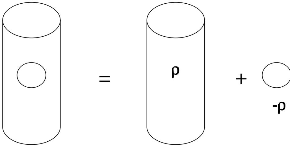
Para calcular el campo eléctrico producido por el cilindro se ocupa la ley de Gauss:
