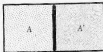
Fig. 1.29 El gas comprimido A' trabaja sobre el gas A cuando el pistón se mueve cierta distancia macroscópica neta.
