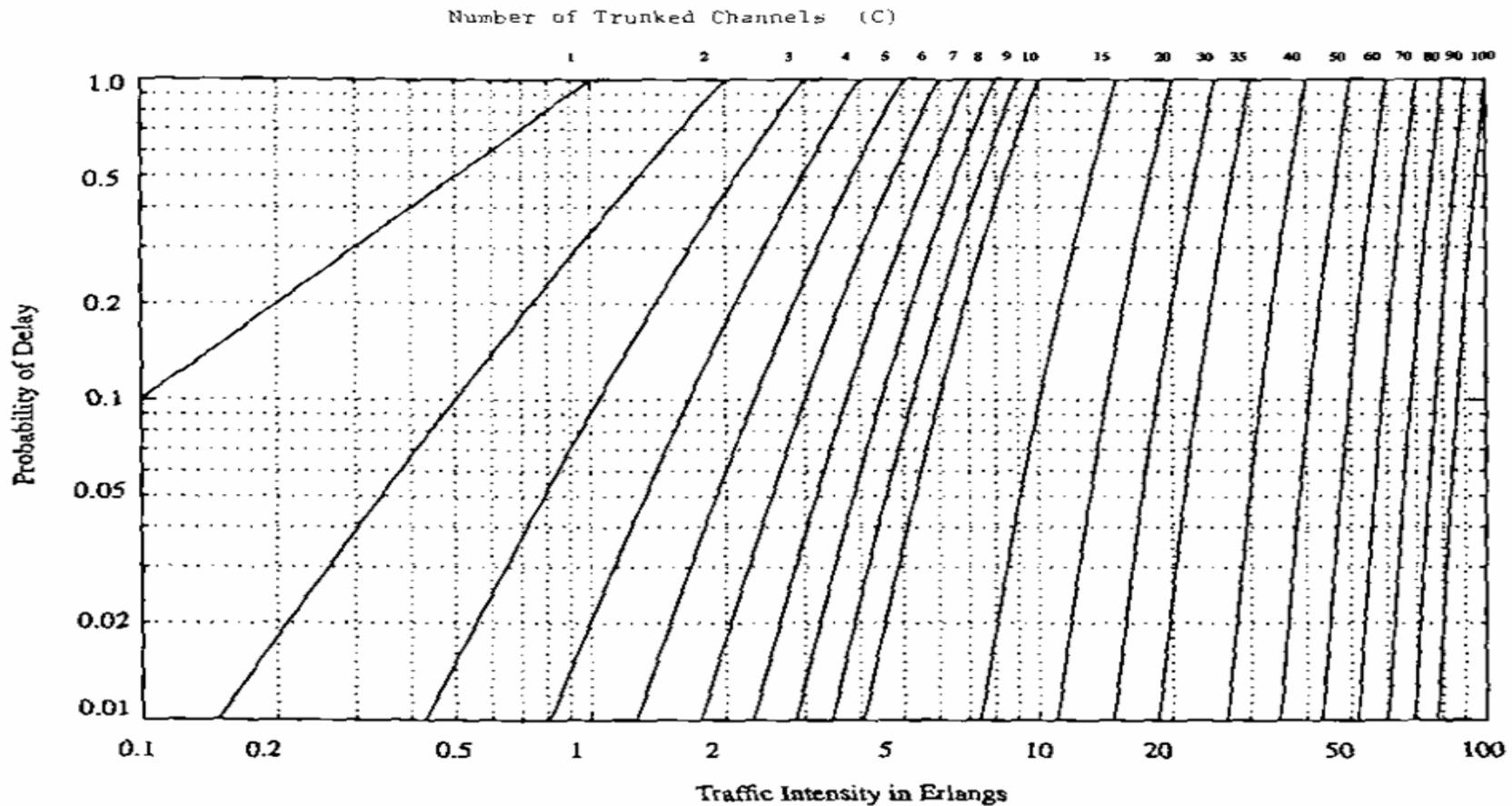
Figura 9.5: Probabilidad que la llamada sea retrasada como una función del número de canales y la intensidad de tráfico en Erlangs.
