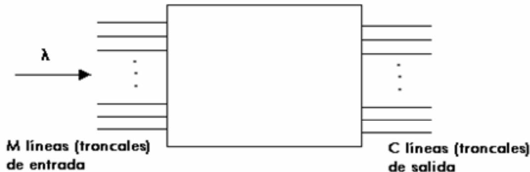
**Figura 9.1:** Modelo genérico de central de conmutación
