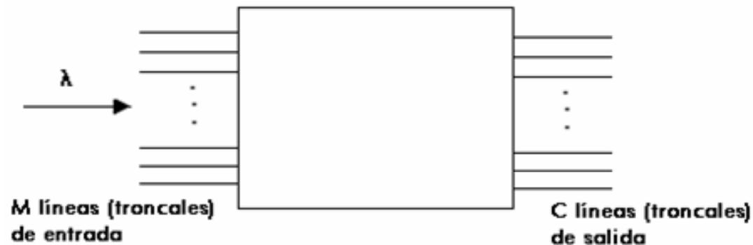
Figura 9.1: Modelo genérico de central de conmutación (9.4)
