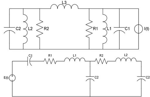
Figura 7: Circuitos eléctrico análogos del ejemplo 2 (Formulación por nodos y mallas respectivamente).
