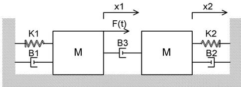
Figura 6. Sistema mecánico de varios elementos
