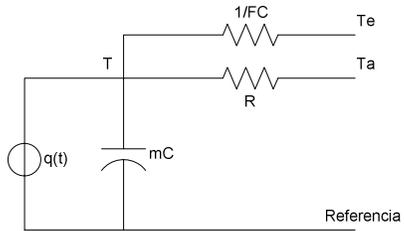
Figura 11: Circuito eléctrico análogo del calefactor de agua.
