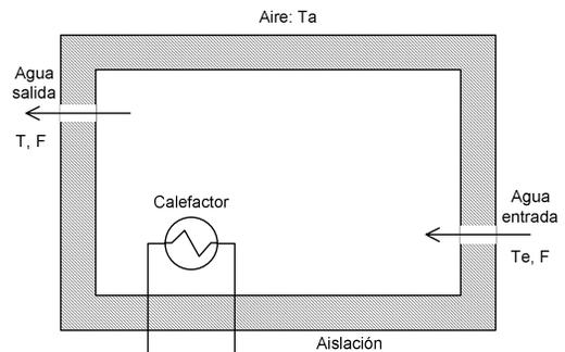
Figura 10: Calentador eléctrico de agua.
