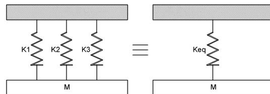
Figura 1: Conexión paralelo de resortes.
