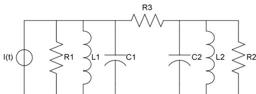
Figura 9: Circuito eléctrico equivalente al sistema mecánico de la figura 8
