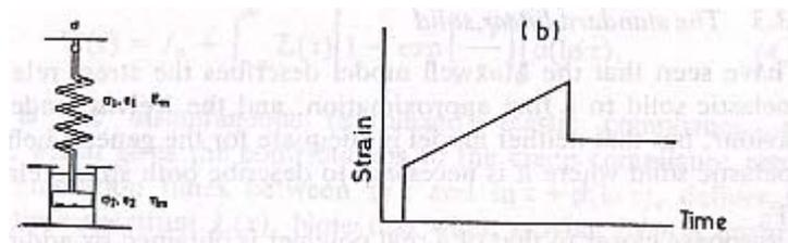
Este modelo consiste de un **resorte** y un **amortiguador** conectados en **serie**
