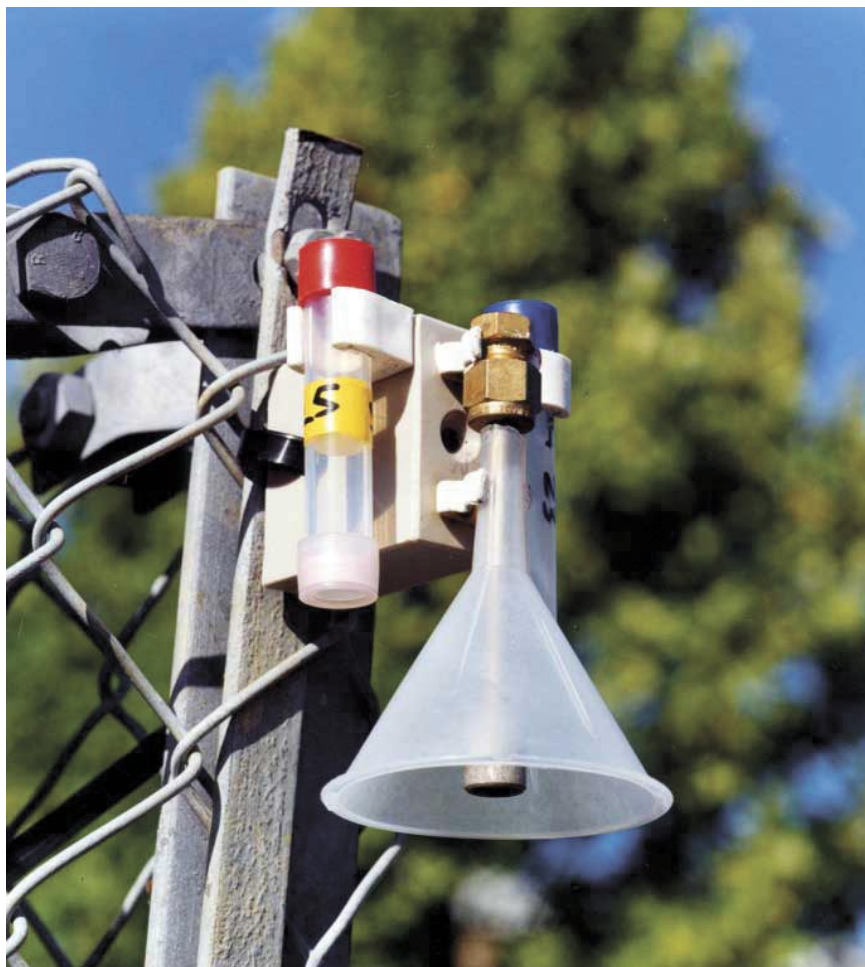
Fig. 8 Protectores y buenos montajes son esenciales en estudios de captadores de muestras pasivos.
