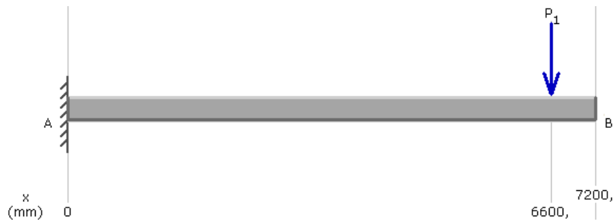
Figura 1: Diagrama de cuerpo libre del poste.
