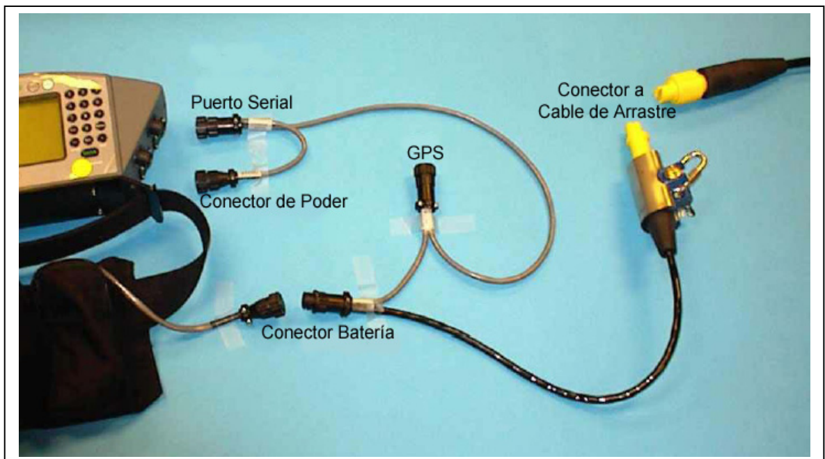
Figura 2.2: Conectores de la Consola.
