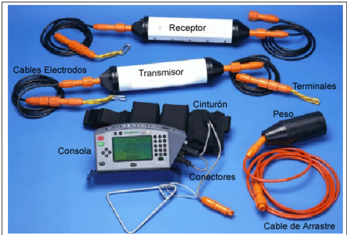
Figura 2.1: Componentes del Ohmmapper.
