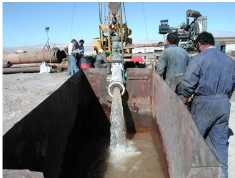
Figura 2.6. - Prueba de gasto, mediante tubo de aforo.
