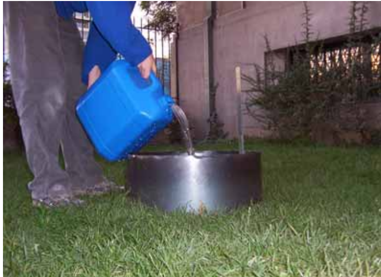
Figura 6: Rellenando el infiltrómetro con agua.
