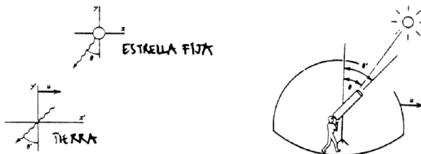
Figura VII.35: A la izquierda aparecen los dos sistemas de referencia que están en movimiento relativo. A la derecha se da una idea del cambio de dirección que se le debe dar al telescopio para enfocar la estrella fija (sin movimiento propio).
