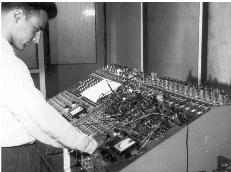
Computador Analógico Heathkit armado en el Laboratorio de Computadores y Servomecanismos
