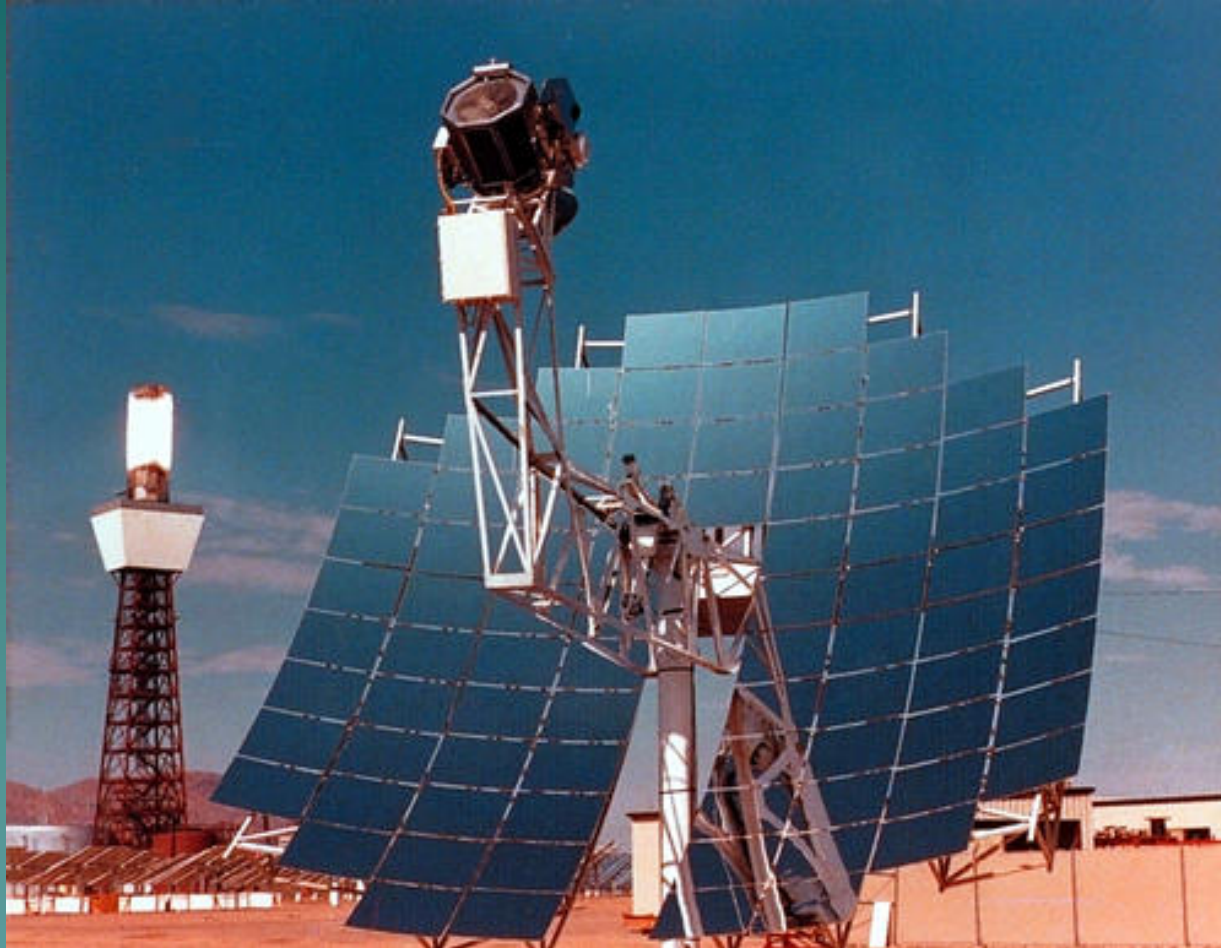
Sistema solar con motor Stirling para generación eléctrica. 50 kW potencia
