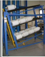
Botellas Agitadas Sobre Rodillo (1- 5 kg)
