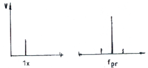
Figura 1.3: Picos típicos en el espectro de vibración de un motor trifásico
