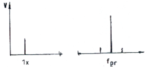
Figura 3.3: Picos típicos en el espectro de vibración de un motor trifásico
