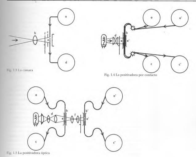
nilla (c), hasta otro chasis que recoge el rollo (d). La lente concentra la luz reflejada en cada fotograma de la película (e). El mecanismo mueve la película de forma intermitente, con una breve pausa mientras el fotograma se mantiene en la ventanilla. El obturador (f) admite la luz a través de la lente solamente cuando el fotograma está inmóvil y listo para la exposición. La velocidad de filmación estándar en las películas sonoras es de 24 fotogramas por segundo.
