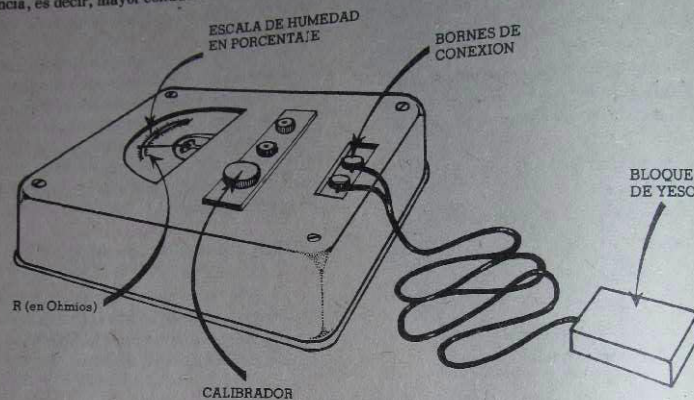
FIGURA 3.15. Medidor de humedad con sus componentes.
