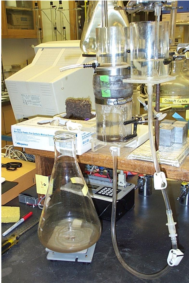
Determinación de la conductividad hidráulica con el método de caída de columna de agua
