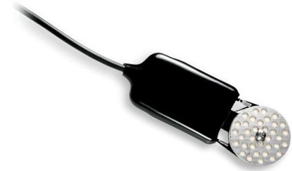
Instrumentos utilizados para determinar el potencial de agua del suelo
