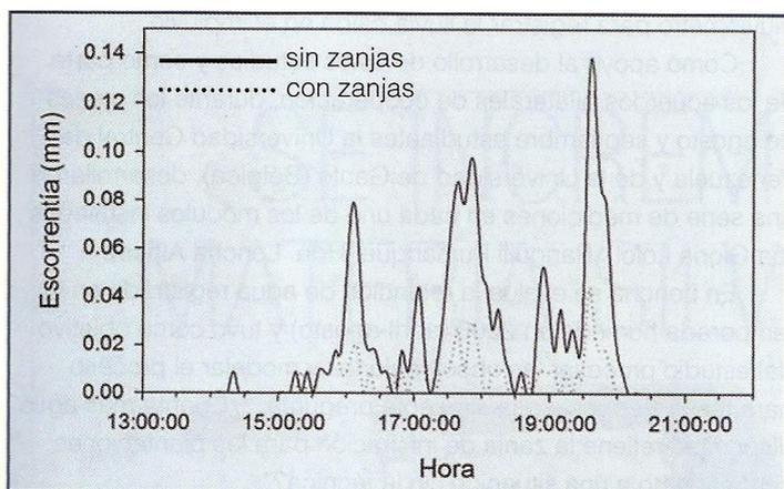
Figura 1: Valores de Escorrentía superficial en sectores con y sin zanjas de infiltración
