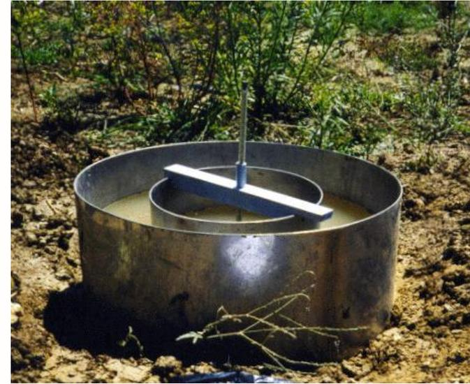
Infiltrómetro de doble anillo
