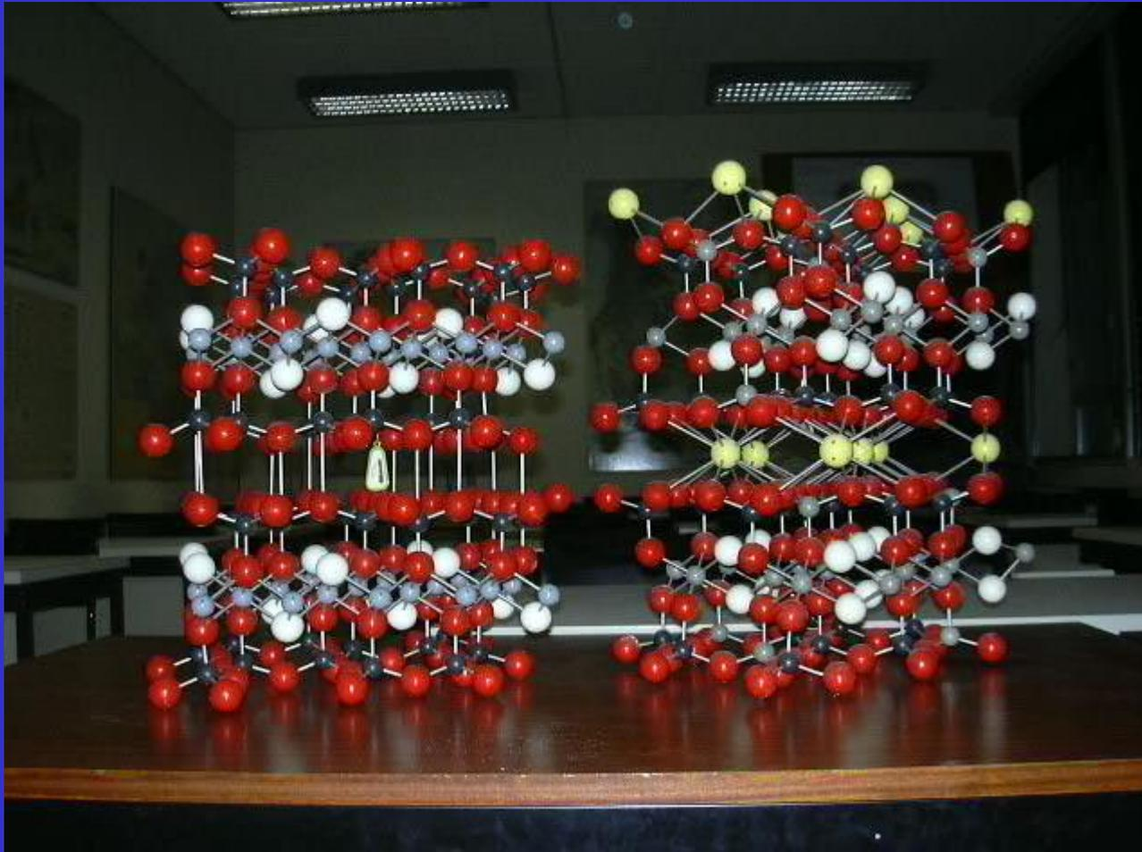
Esquema más complejo (pero muy didáctico) de visualización de la estructura mineral de una arcilla silicatada. La próxima imagen sirve para captar el enlace entre estructuras mediante el compartir los oxígenos.
