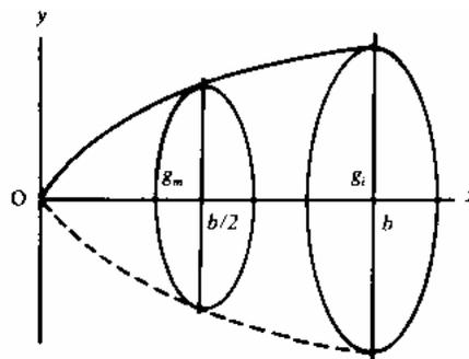
El factor de forma para reducir el volumen de un cilindro al de un paraboloides es 0,5.
