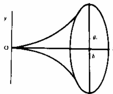
El factor de forma para reducir el volumen de un cilindro al de un paraboloides es 0,25.
