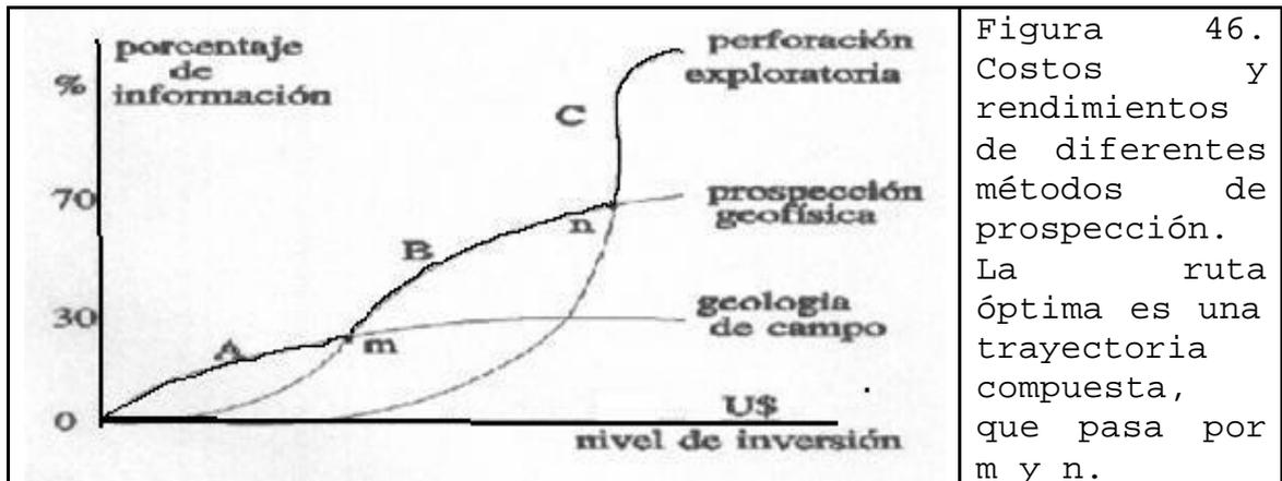
Figura 46. Costos y rendimientos de diferentes métodos de prospección. La ruta óptima es una trayectoria compuesta, que pasa por m y n.
