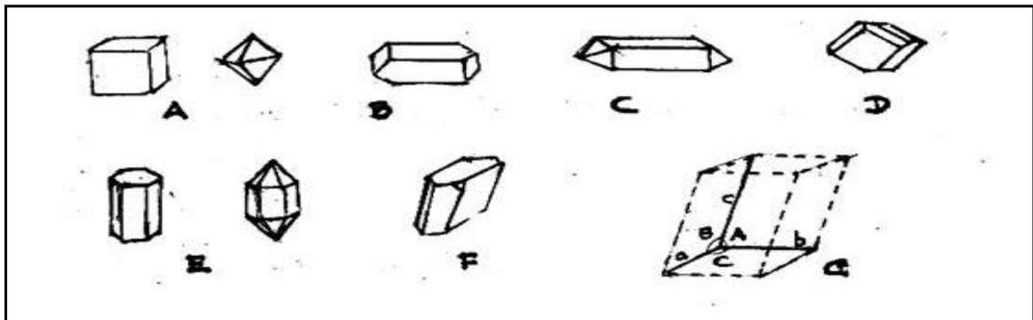
Figura 19. Ejemplos de cristales sistema por sistema. A. Halita y fluorita (cúbico), B. aragonita (Ortorrómbico), C. calcón (tetragonal), D. calcita (romboédrico), E. Nefelina y cuarzo (hexagonal), F. calcantita (triclínico), G. elementos del cristal. Por la forma, prismático (A izquierda), piramidal (A derecha), tabular (F), columnar (E). Tomados de Diccionario Rioduero de Geología y Mineralogía.
