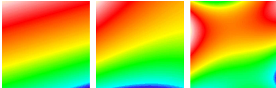
FIGURA VII-4. Izquierda: ajuste de grado 1 para un set de puntos; centro: ajuste de grado 2; derecha: ajuste de grado 3.
