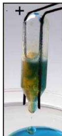
Fig. 2. Izquierda: montaje para la electrólisis del agua con recolección de hidrógeno y oxígeno juntos (indicador de azul de bromotimol fue usado como indicador. Como sostener el aparato: la reacción inicia cuando los alambres
