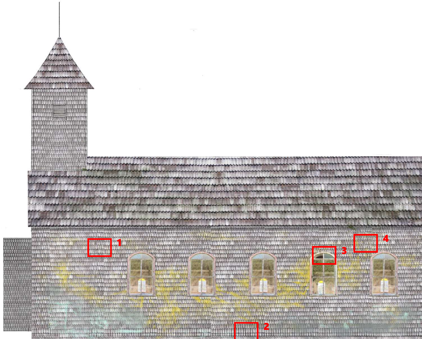
Figura 17.1. Ubicación de las patologías externas en el lateral derecho.
