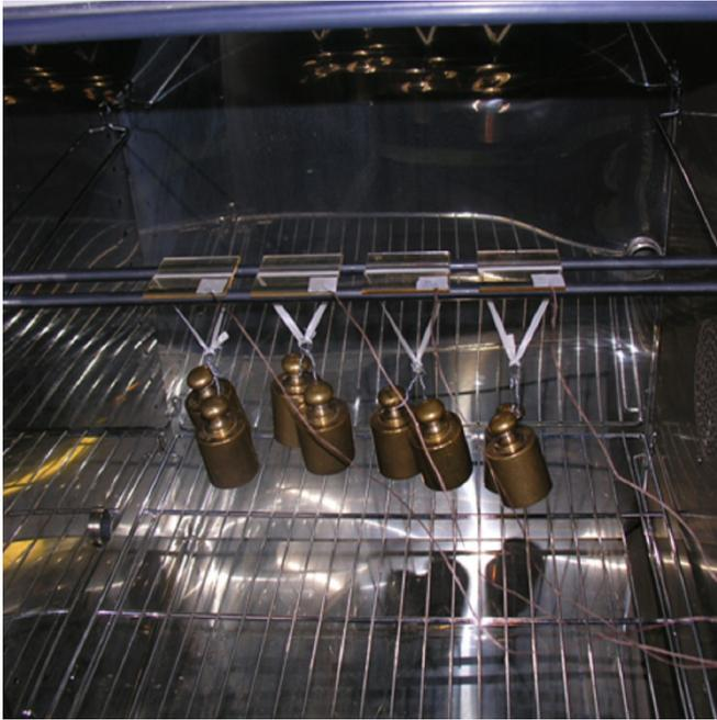
Allo scopo di prevenire deformazioni plastiche dovute a urti o spinte accidentali si testa la rigidità dei diversi polimeri ad alta temperatura. Ai materiali da testare vengono applicati dei pesi, quindi i campioni vengono introdotti in una camera climatica.
