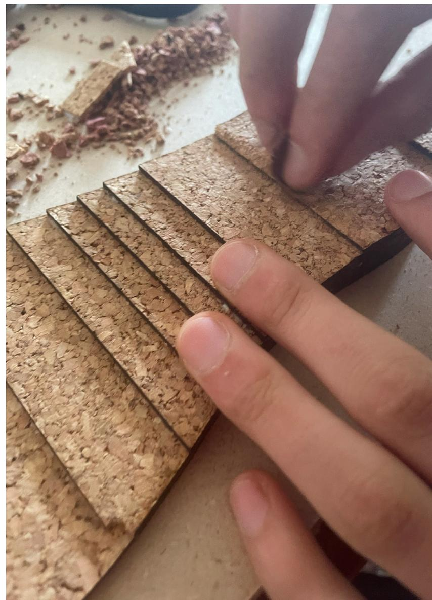
Figura 79. Proceso de lijado de los cantos. Elaboración propia.
