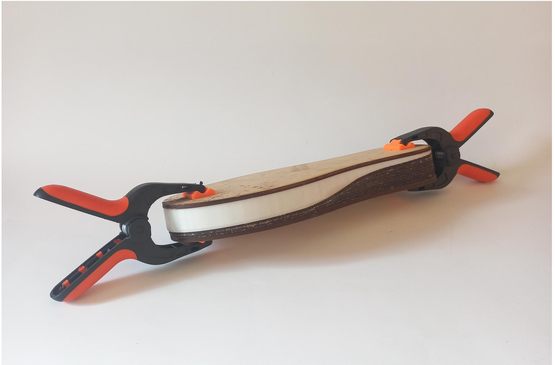
Figura 83. Contraforma sobrepuesta en la entresuela aplicando presión. Elaboración propia.
