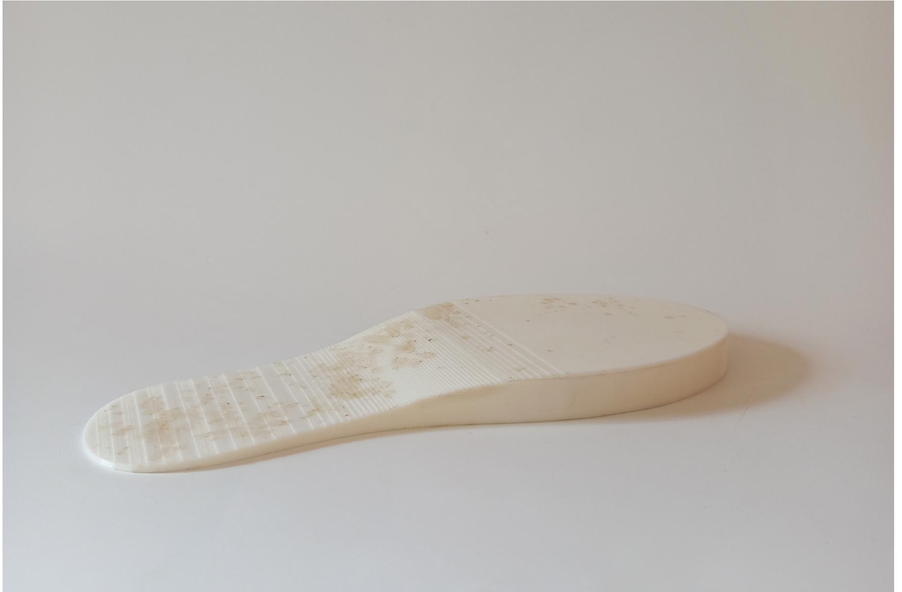
Figura 82. Contraforma impresa. Elaboración propia.
