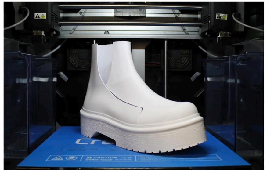
Figura 35. Prototipo impreso en 3D (KoojLab, 2022)
