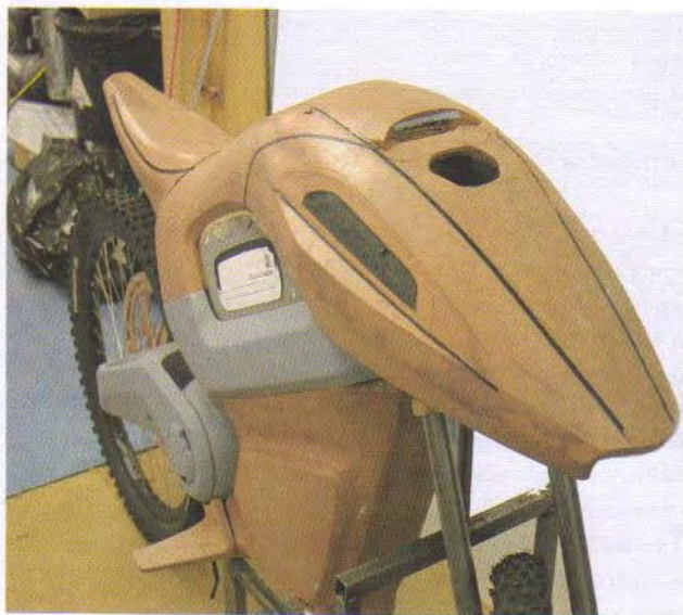
Fig. 9 Modelos de apariencia a escala natural; por un lado, prototipos de arcilla creados para hacerse una idea del chasis y la ergonomía del vehículo; por el otro, un modelo CAD que muestra las suaves curvas de la carrocería.
