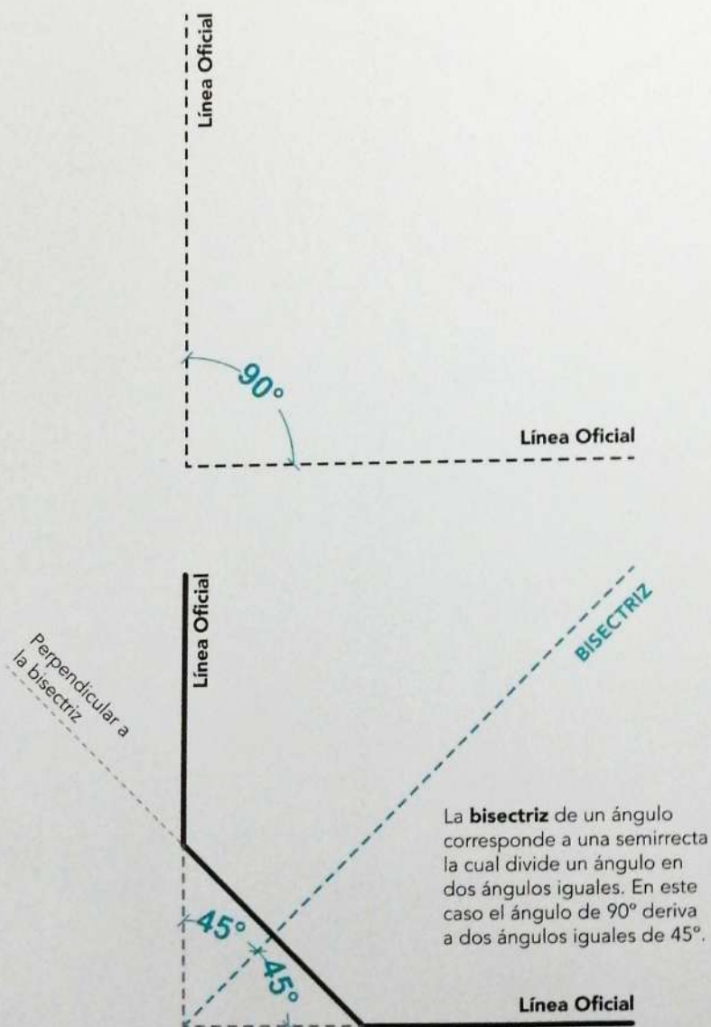
Figura 1: Trazado de un ochavo entre líneas oficiales que forman un ángulo de 90^\circ
