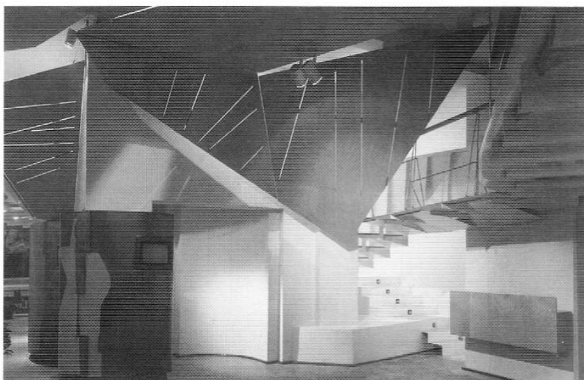
5. Las construcciones con grandes paneles, como ésta de Nadeco en Pamplona, ejemplifican los componentes. Las piezas llegan a la obra totalmente elaboradas y ningún proceso de conformación es posible. Su manipulación se reduce al montaje.
