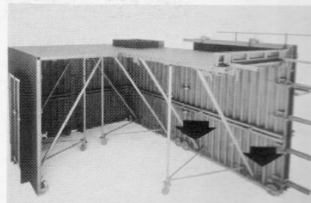
12. Otra evolución de las técnicas de moldeado apunta hacia el incremento de tamaño del molde. El más espectacular es el encofrado túnel , conjunto de moldes metálicos que forman grandes cajones invertidos, sobre y entre los cuales se vierte el hormigón.
