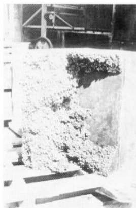
9. La eficacia del vibrado puede apreciarse en esta figura. Se formó en un cajón una capa de árido ligero y sobre ella se vertió una lechada de cemento. El macizo se separó en dos partes por una chapa de madera y se vibró el lado derecho. En este lado el cemento llegó al fondo del cajón y formó un dado compacto. En el izquierdo, la lechada sólo penetró unos centímetros.
