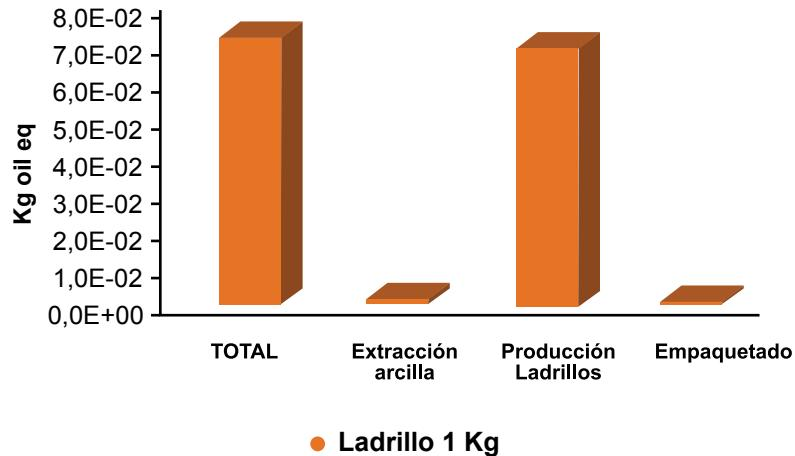
Figura N° 39 Grafico de barras de Agotamiento fósil por entradas y salidas del Ladrillo
