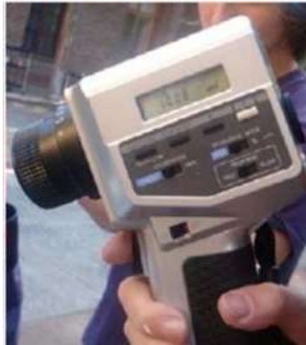
Luminancímetro Minolta LS100 Calibrado ISO/CIE 19476:2014
