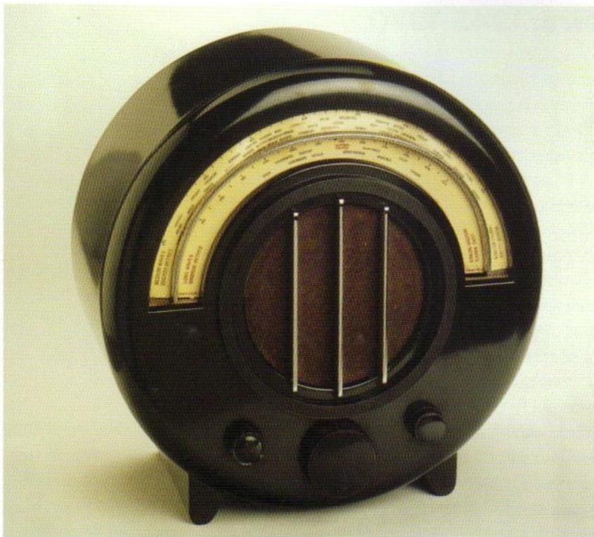
Radio Wireless, Ekco AD-65, diseñada por Wells Coates en 1932. La baquelita, llamada así por su inventor, Leo Baekeland, fue el primer plástico empleado para hacer radios, y resultaba ideal para los diseños estilo Art Déco de las décadas de 1920 y 1930. Era práctico por ser moldeable y por sus buenas propiedades como aislante eléctrico.
