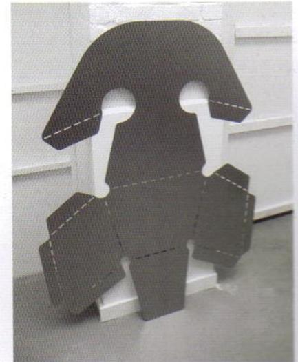
Silla de lámina de metal (2008), diseñada y producida por Max Lamb. Primero se conforma una sola lámina de metal (arriba); después, se pliega a lo largo de los orificios para montarla (arriba e izquierda).
