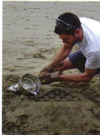
Banqueta de peltre (2006), diseñada y realizada por Max Lamb. Moldeada sobre un patrón de arena en una playa, adquiere su forma cuando la marea enfría el metal fundido.
