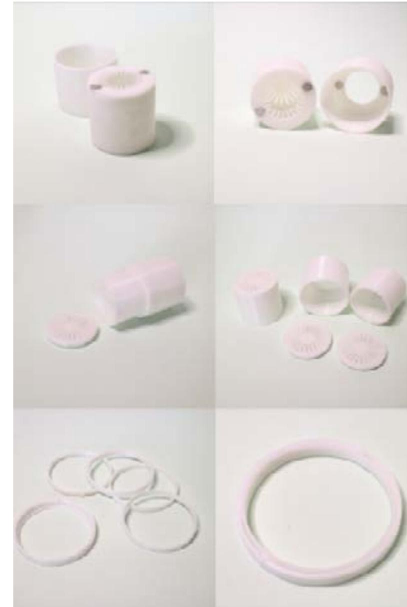
Imagen x. Fotografía revisión de acoples y tolerancia de encajes. Elaboración propia.
