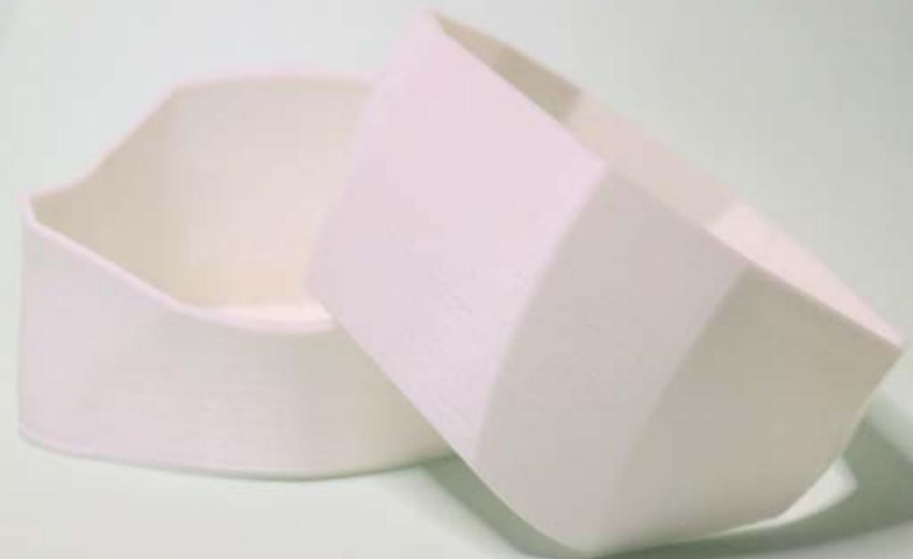
**Imagen x.** Fotografía de prototipos impresos en 3D del cuerpo del dispositivo. Elaboración propia.
