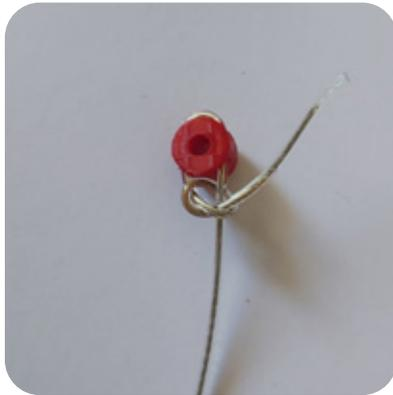
Figura 86: Conector tensores con cable de acero.
