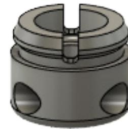
Figura 84: Modelo 3D Conector tensores
