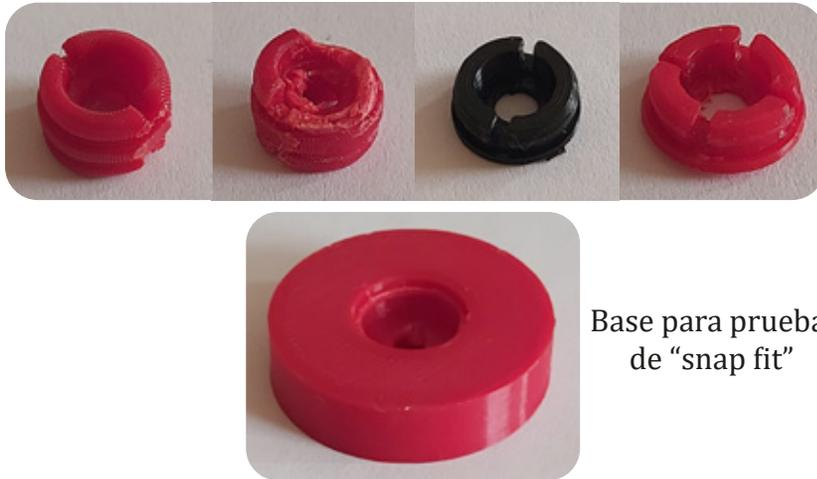
Figura 54: Prototipos "snap fit" fallidos .
