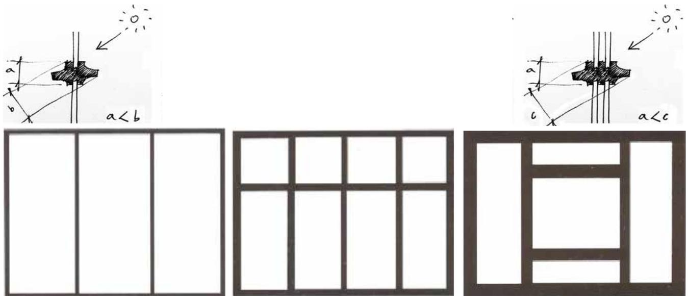
Figura 1.95: Esquemas de obstrucción de los marcos de ventanas en un 10%, 25% y 40%. Arriba, esquemas de cómo el espesor de los marcos (para vidrios par) puede también disminuir e acceso de luz de una ventana. Fuente: Archivo de la autora.
