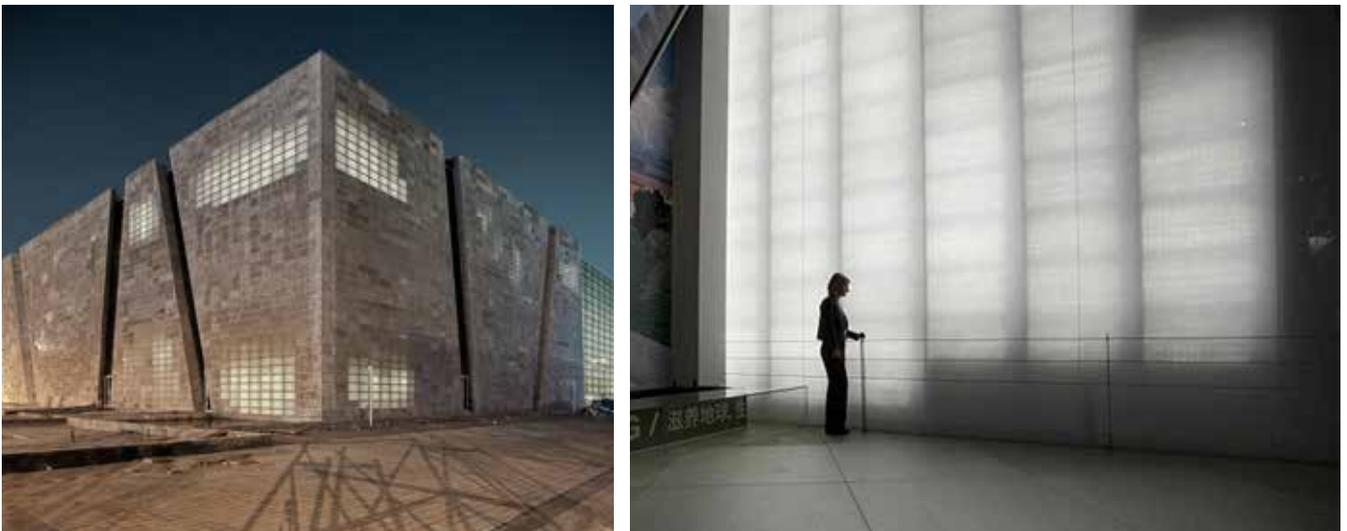
Figura 1.50: Cemento translúcido Litracon en el pabellón italiano en la Expo de Shanghai. Fuente: Oliver Blum y [blogs.lainformacion.com](http://blogs.lainformacion.com). Abajo: Litracon y experimentaciones con barras acrílicas. Fuente: [www.litracon.hu](http://www.litracon.hu) y [www.makearchitecture.wordpress.com](http://www.makearchitecture.wordpress.com)
