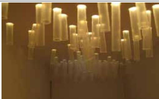
El sistema de iluminación por lumiductos es una variante contemporánea y de alta tecnología del patio de luz. Utiliza el principio de reflexión interna en las paredes del ducto, la que puede ser reflexión normal o reflexión interna total en materiales transparentes.
