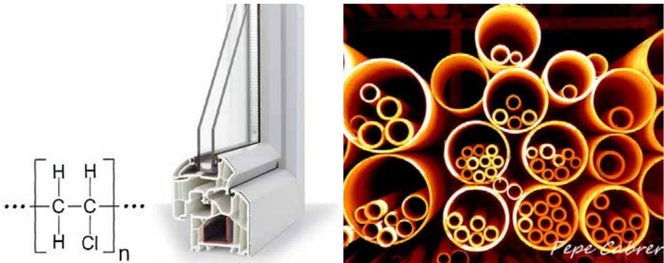
Figura 1.39: Estructura molecular del PVC. Productos comerciales en planchas y perfiles de ventanas. Fuente: Plastics. Engelsmann, et al. 2010. Productos comerciales de PVC para arquitectura, tubos y textiles. Fuente: [www.archiexpo.es](http://www.archiexpo.es), enero de 2013. KunstHüle. Arquitectos: OSA (Office of Suversive Architecture) Fuente: [www.plataformaarquitectura.cl](http://www.plataformaarquitectura.cl), enero de 2013.
