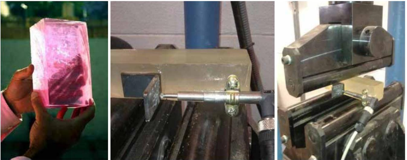
Figura 1.49: Cemento transparente en base a resinas desarrollado en México. Fuente: [www.plataformaarquitectura.cl](http://www.plataformaarquitectura.cl) y Martínez Bosch, M. C. (2011). Hormigón translúcido con fibra óptica. Tesis de grado de la Universidad Politécnica de Valencia en <http://riunet.upv.es> consulta en febrero de 2013).
