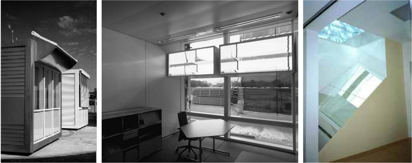
Figura 1.90: Sistemas anidólios aplicados en prototipos y sistema de recepción de luz en subterráneos. Fuentes: <http://leso.epfl.ch>.
