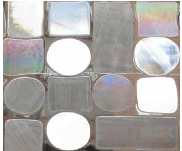
Figura 1.10: Difracción e Interferencia. Superposición de ondas (zonas de más o menos luz). c. Fenómeno de interferencia en un film adhesivo para vidrios, producido por el paso de la luz a través del delgado espesor de su superficie (1000 nm variable). Fuentes: Archivo de la autora.
