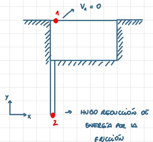
2. La tubería del problema anterior llena el pozo de base 8 mt por 8 mt, por un período de 10 hrs ¿Qué altura debe tener el pozo? Este pozo se utilizará para abastecer de agua un edificio.
