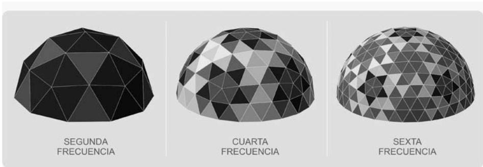
Fig. 74. Cúpulas geodésicas que aumentan de frecuencia.
