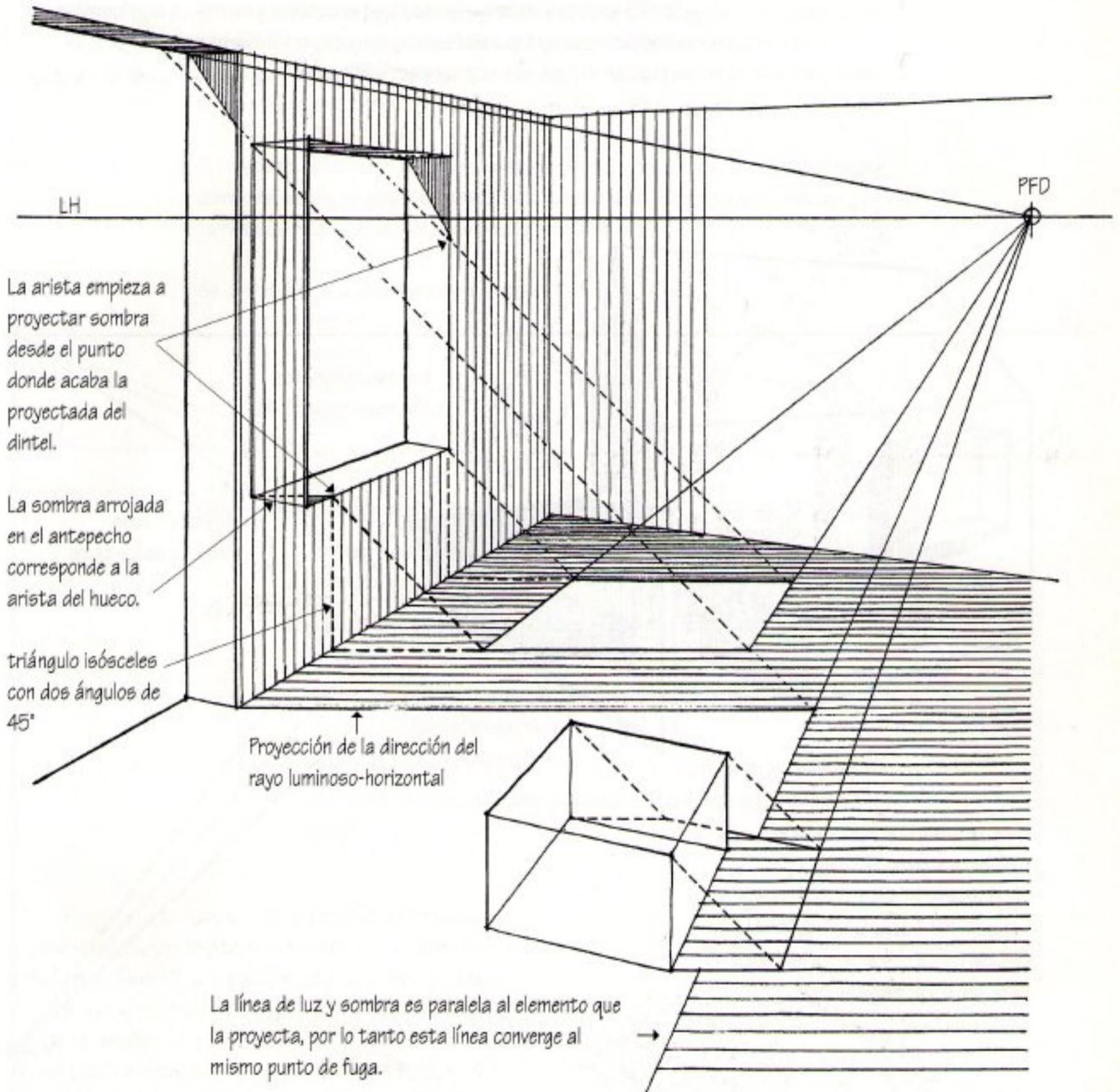
Las sombras que proyectan los rayos luminosos que no sean paralelos al plano del cuadro se construyen de modo parecido al utilizado en la perspectiva de una fuga. Primero se sitúa el punto de fuga de la proyección de la dirección de los rayos (PF-PD) sobre la línea de horizonte. Seguidamente se prolonga un rayo luminoso existente hasta cortar a una vertical trazada por PF-PD. La intersección (PV) es el punto de fuga de todos los rayos luminosos.
