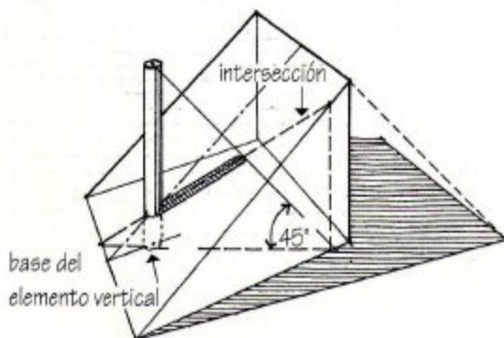
Para determinar cómo proyecta una sombra un elemento vertical sobre una superficie inclinada, se prolonga el primero hacia abajo hasta la base de la segunda. Tomando como lado el elemento vertical, se construye un triángulo isósceles que tenga dos ángulos de  $45^\circ$ . El segmento determinado en la intersección del plano del triángulo y del plano inclinado por el elemento vertical y la hipotenusa mencionado será la sombra arrojada que se buscaba.
