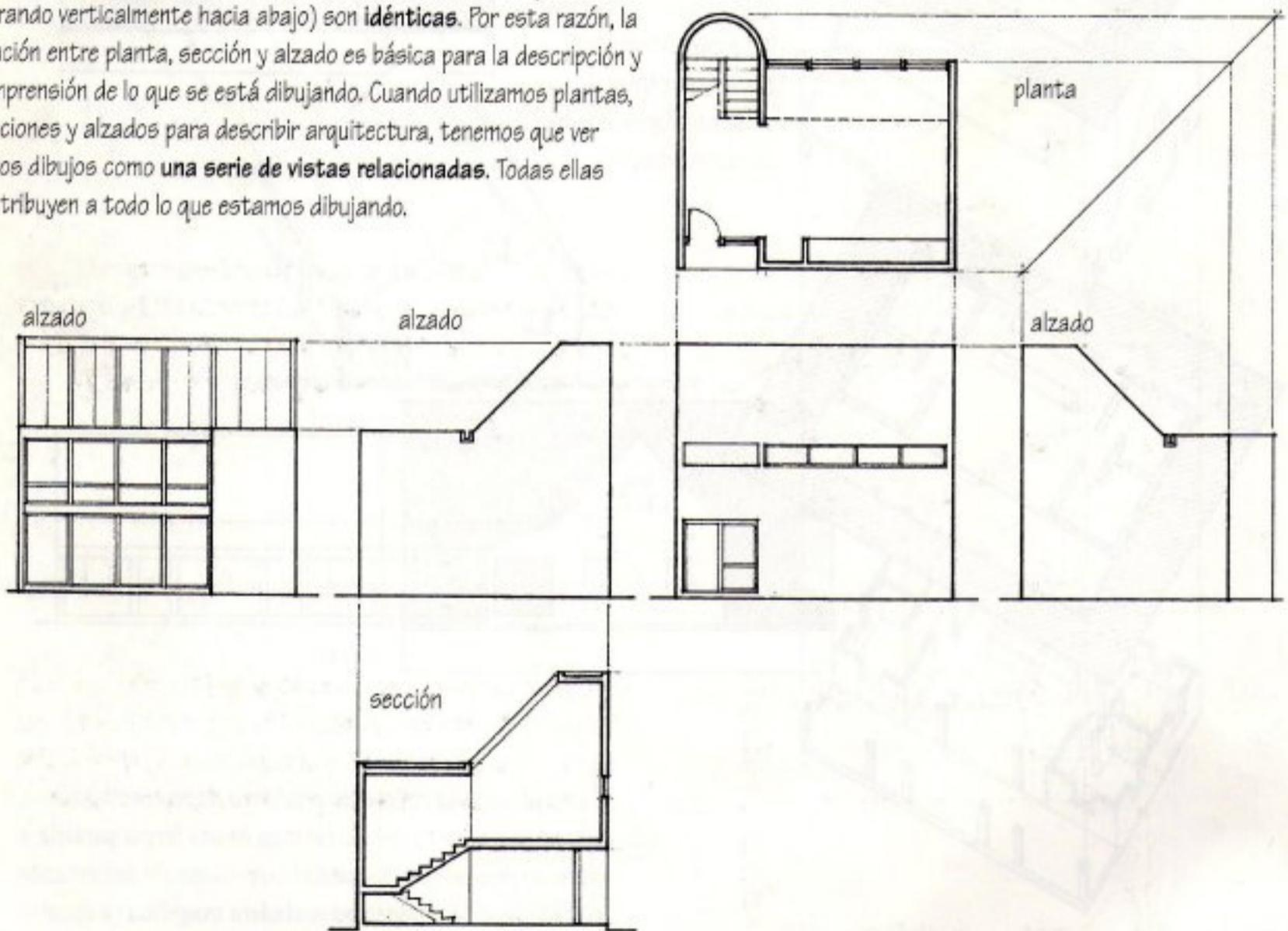
La **planta** y la **sección** (ver páginas 34-35) son secciones o cortes: en la planta se corta horizontalmente; en la sección, verticalmente. Mientras que en los planos de obra (hechos para la construcción del proyecto) las plantas y las secciones muestran cómo se unen las distintas partes de un edificio, en
