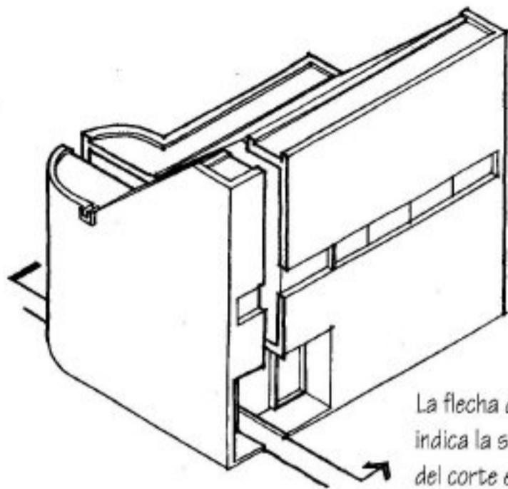
La **sección de un edificio** es una vista horizontal después de haberlo cortado según un plano vertical y separado la parte anterior.
