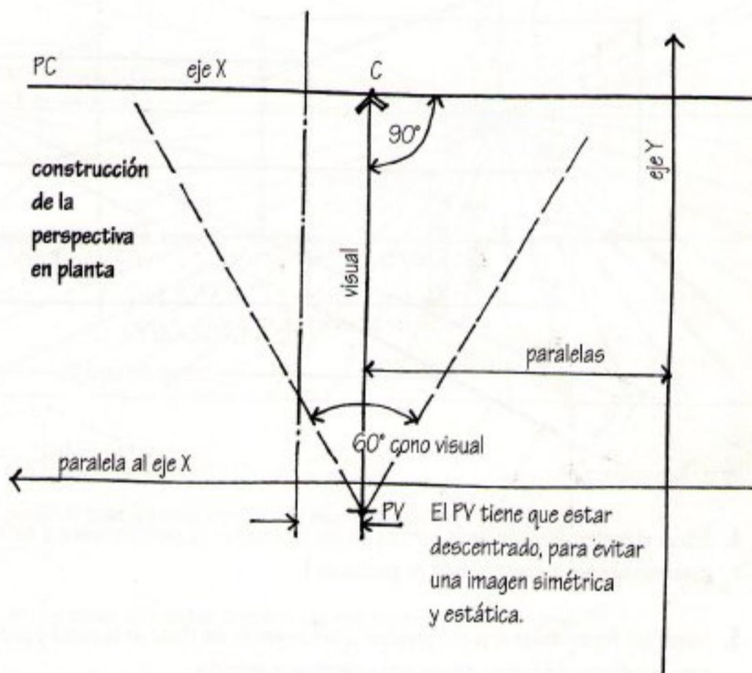
La posición del PC en referencia al PV determina el tamaño final del dibujo (ver página 62); la posición más práctica del PC para facilitar la construcción es haciéndolo coincidir con un plano principal perpendicular a la visual del observador
