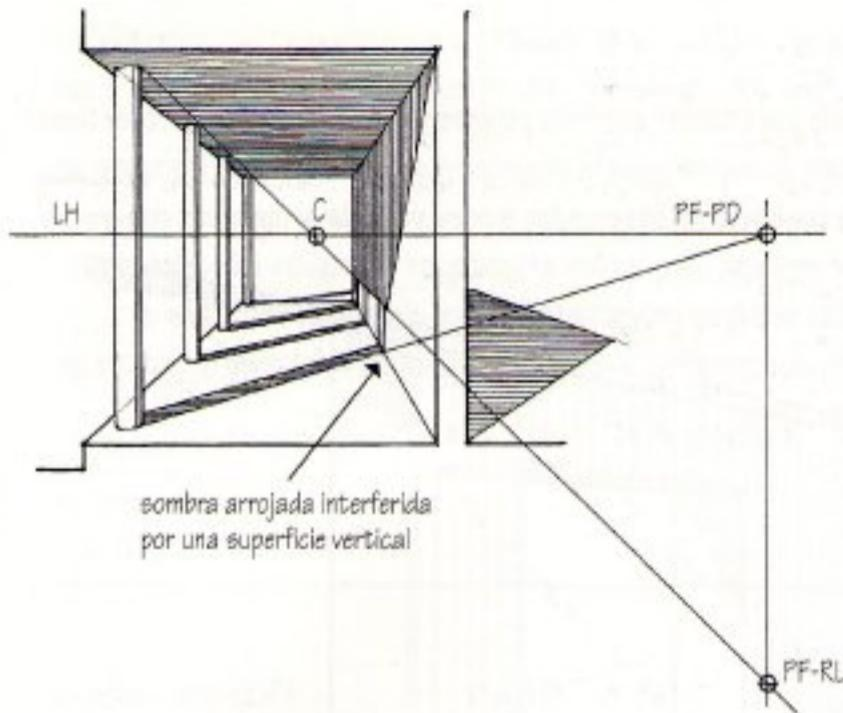
Donde un plano vertical o inclinado intercepta una sombra sobre uno horizontal, se imaginará que un triángulo isósceles con dos ángulos de  $45^\circ$  corta a la superficie interceptora. La intersección representa la continuación de la línea de sombra.
