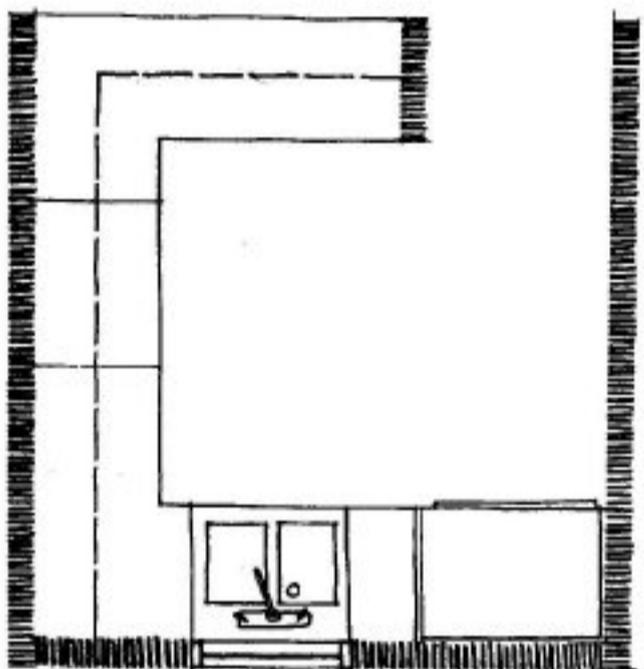
Hay que notar que lo que está seccionado en planta (paredes, columnas, etc.) tiene prioridad y hay que marcarlo con líneas de valor dominante; lo que queda visto en el plano (pavimento, repisas, muebles, etc.) tiene que tener un valor más ligero (ver capítulo 4 para la ejecución de texturas).
