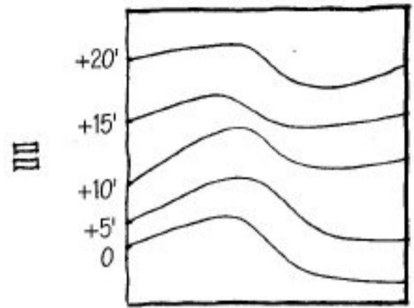
Las curvas de nivel representan los cambios de la topografía en los dibujos ortogonales a base de líneas de igual cota. Si comprende las curvas de nivel, un observador puede hacerse una idea bastante precisa de la configuración del terreno a partir de un plano bidimensional.
