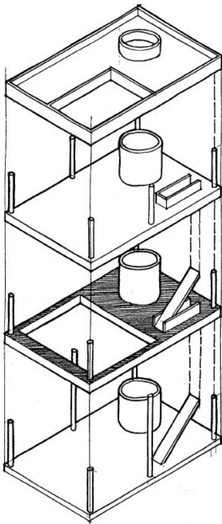
Para enseñar cómo se relacionan entre sí los componentes constructivos de un edificio y/o mostrar selectivamente los espacios interiores cabe expandir la forma constructiva según los ejes x-y-z de una axonometría. Otro procedimiento para alcanzar el segundo de estos objetivos, sin desplazar los elementos, consiste en graficarlos como si fueran transparentes.
