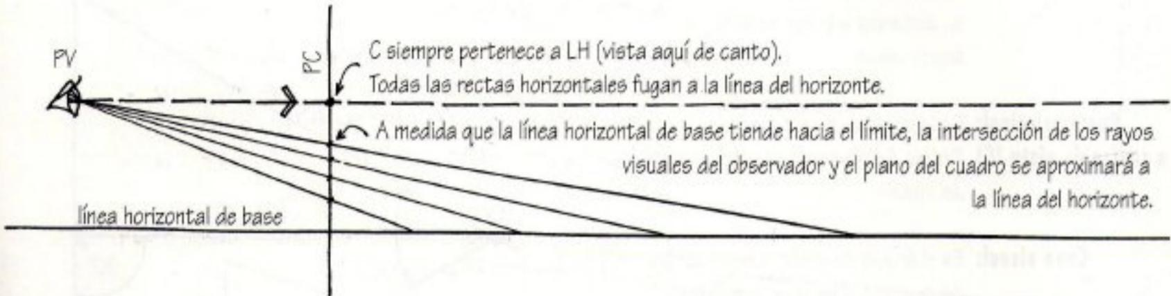
**Plano geometral (PG):** Es el plano horizontal de referencia, desde el cual se toman las medidas verticales; la altura de la línea del horizonte (LH) sobre el plano geometral es siempre la misma que la altura del observador (PV).
