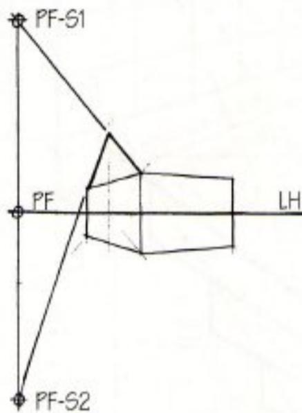
Ambas líneas se prolongan hasta cortar a una perpendicular a la línea de tierra por el punto de fuga correspondiente a las líneas horizontales del hastial. Los puntos de intersección serán los de fuga para las líneas en pendiente y las paralelas a éstas.
