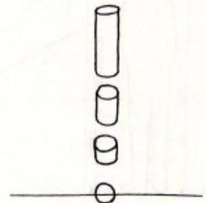
En perspectiva, las perpendiculares a la línea del horizonte del observador parecen disminuir al girar hacia el observador
