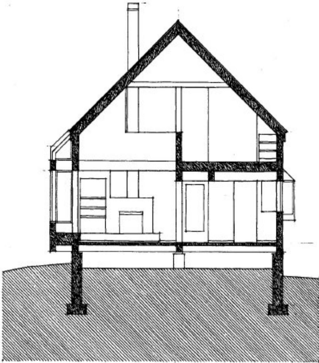
En este dibujo se ilustra la manera como los elementos que cortan el plano de sección pueden recibir un valor tonal que eleve el contraste con los que, más allá del corte, se ven en alzado. Esta solución es muy necesaria cuando se presentan muchos elementos en alzado.
