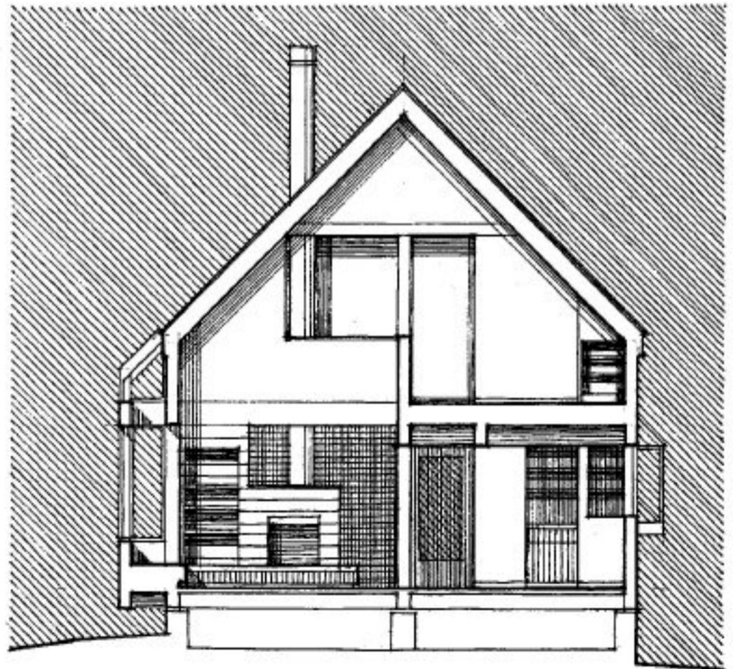
Este último dibujo ejemplifica la posibilidad de invertir el sistema de valores cuando aquello que se ve en alzado se texturiza junto con el fondo. Aquí la sección se puede dejar en blanco o aplicarle un valor bastante claro para contrastar con el campo gráfico.
