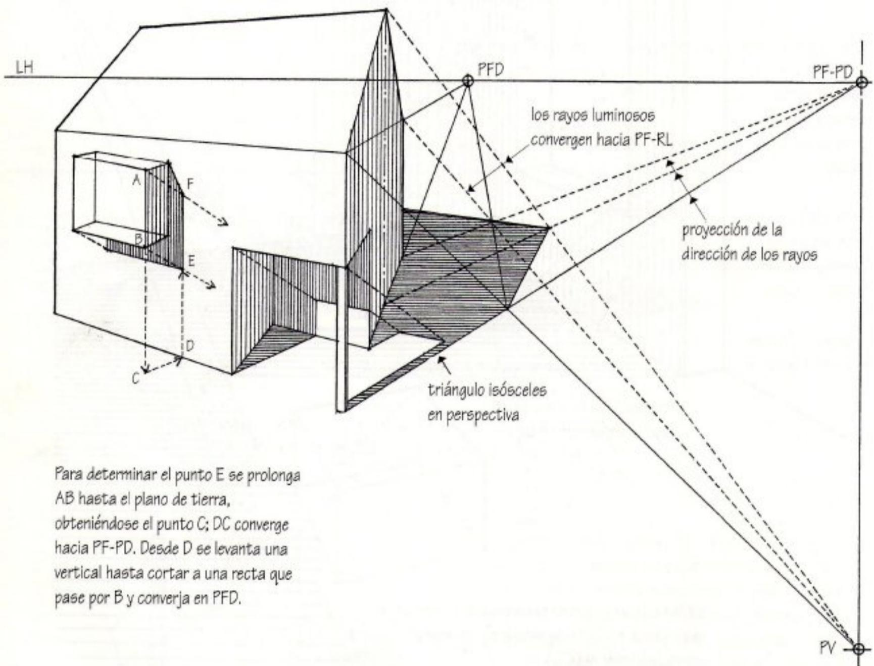
Para determinar el punto E se prolonga AB hasta el plano de tierra, obteniéndose el punto C; DC converge hacia PF-PD. Desde D se levanta una vertical hasta cortar a una recta que pase por B y converja en PFD.
