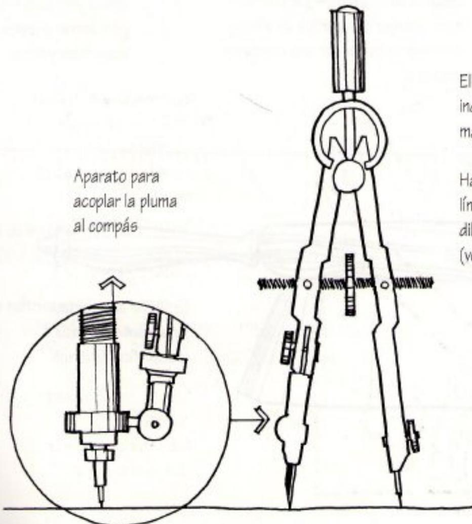
El compás sirve para trazar círculos de radio indeterminado, círculos grandes y para la mayoría del trabajo a tinta.
