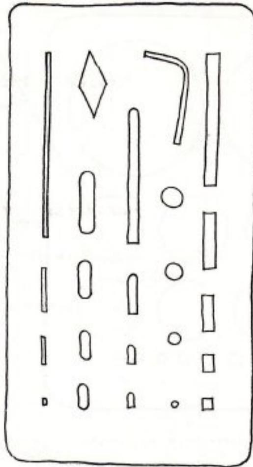
Plantilla para borrar: usar una con huecos cuadrados permite borrar áreas precisas de un dibujo —también sirve para proteger la superficie de dibujo mientras se borra con una borradora eléctrica.
