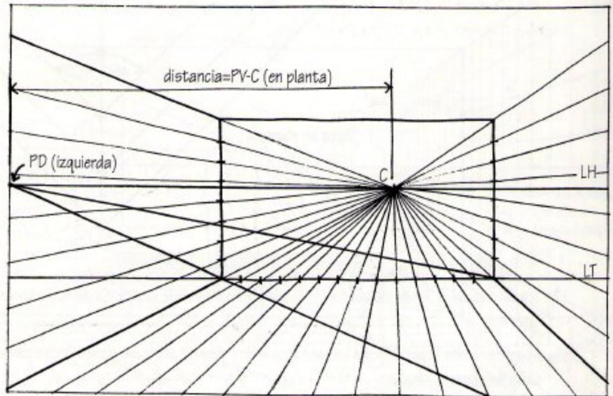
9. Trazar las dos rectas que unen el punto de fuga diagonal con las dos esquinas inferiores de la pared del cuadro.
