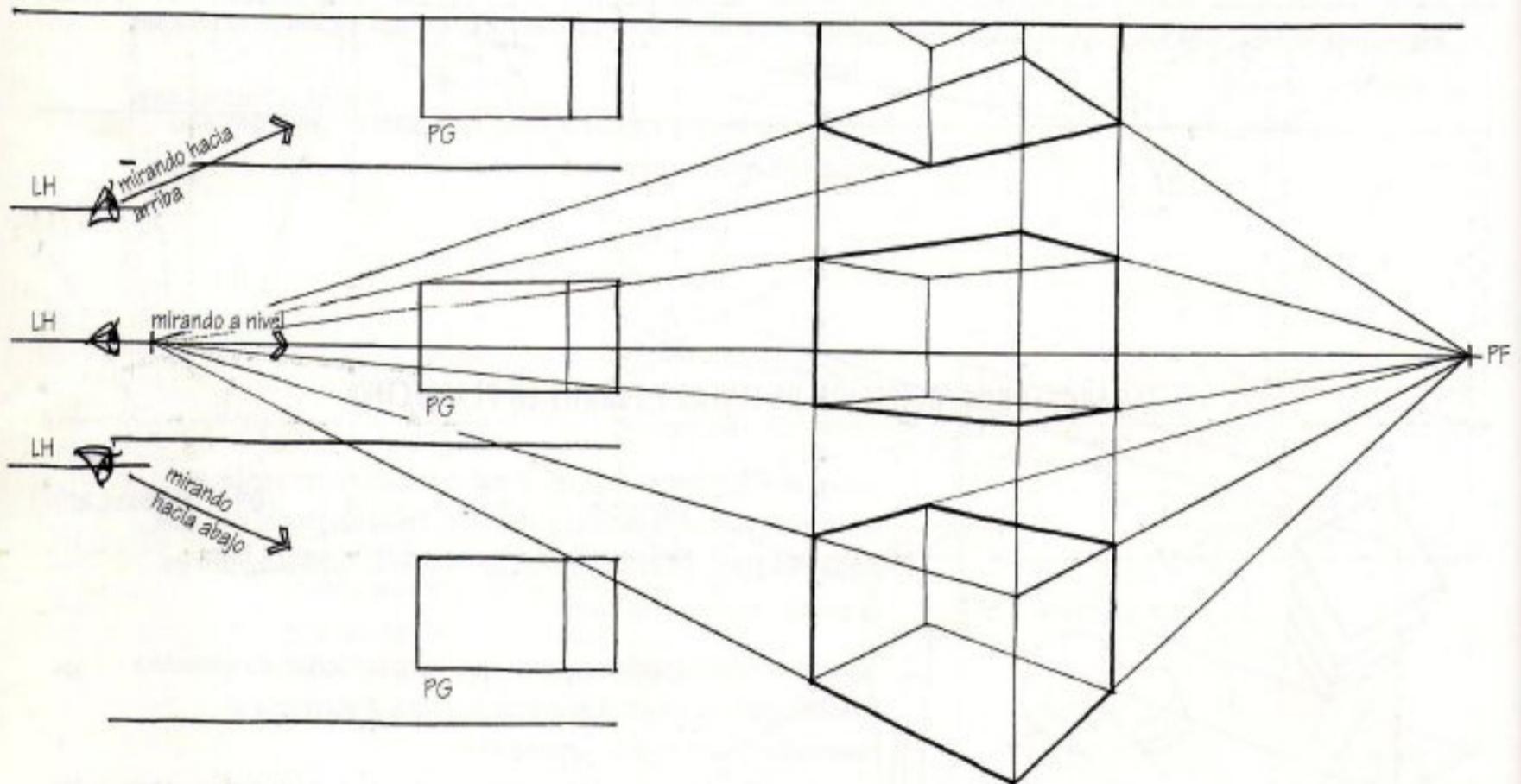
La altura del observador (y por lo tanto, la de la línea del horizonte) con respecto al objeto observado determina si éste se ve desde arriba, desde abajo o desde su mismo nivel. La línea del horizonte y los puntos de fuga situados en ella se mueven para arriba o para abajo al moverse el ojo del observador
