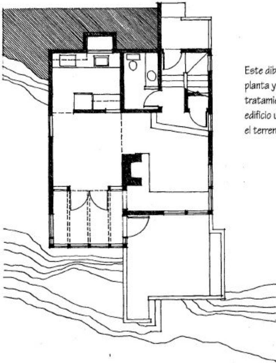
Este dibujo presenta una combinación de representación de la planta y del emplazamiento. La forma de la planta y el tratamiento oscuro que reciben las paredes en sección dan al edificio un carácter figurativo que contrasta suficientemente con el terreno que lo rodea.
