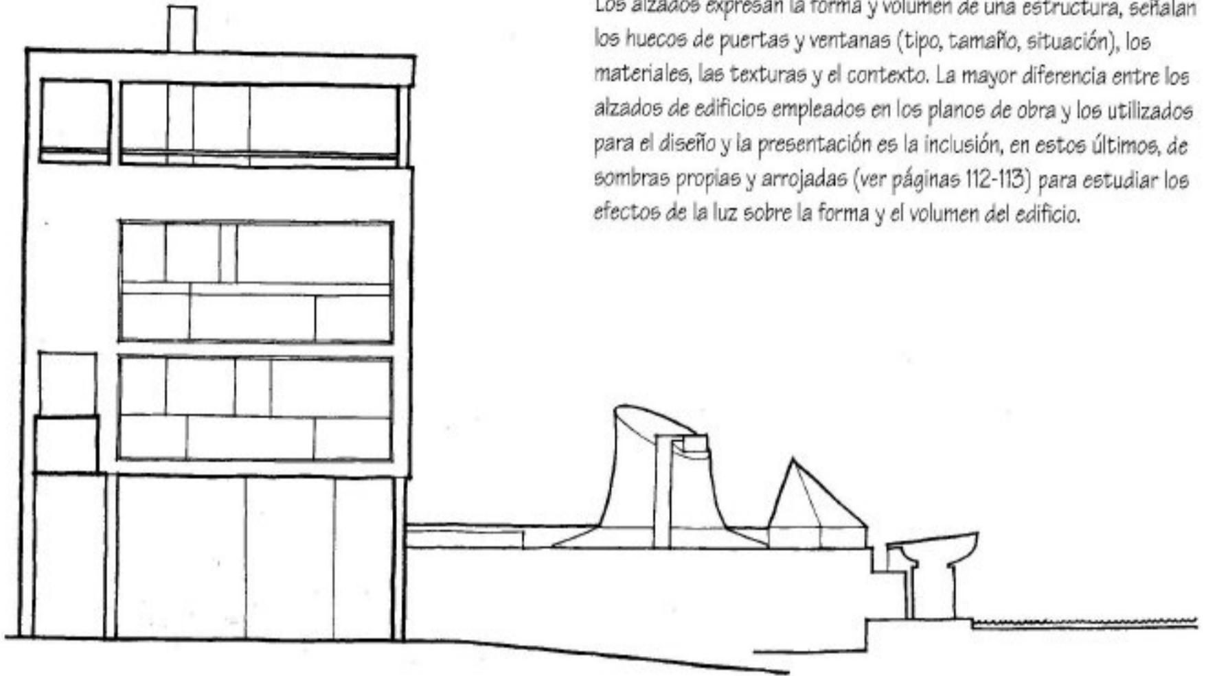
Los alzados expresan la forma y volumen de una estructura, señalan los huecos de puertas y ventanas (tipo, tamaño, situación), los materiales, las texturas y el contexto. La mayor diferencia entre los alzados de edificios empleados en los planos de obra y los utilizados para el diseño y la presentación es la inclusión, en estos últimos, de sombras propias y arrojadas (ver páginas 112-113) para estudiar los efectos de la luz sobre la forma y el volumen del edificio.
