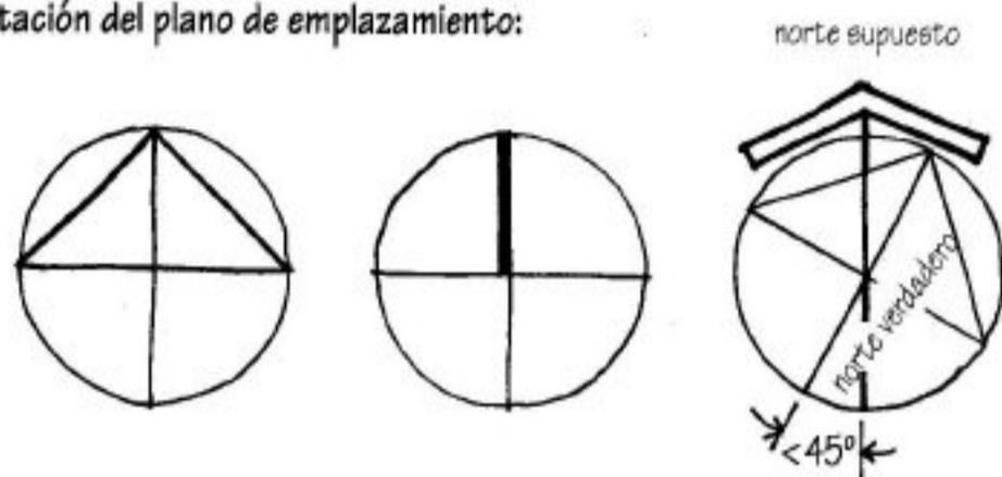
La orientación de un edificio en un plano de emplazamiento se representa con una **flecha de norte**. Siempre que sea posible se hará coincidir el Norte con la dirección abajo-arriba de la hoja de dibujo. Si un edificio está orientado en una dirección que difiera en menos de  $45^\circ$  de uno de los puntos cardinales, se puede utilizar un norte supuesto para evitar que los títulos sean demasiado largos (ver página 40).
