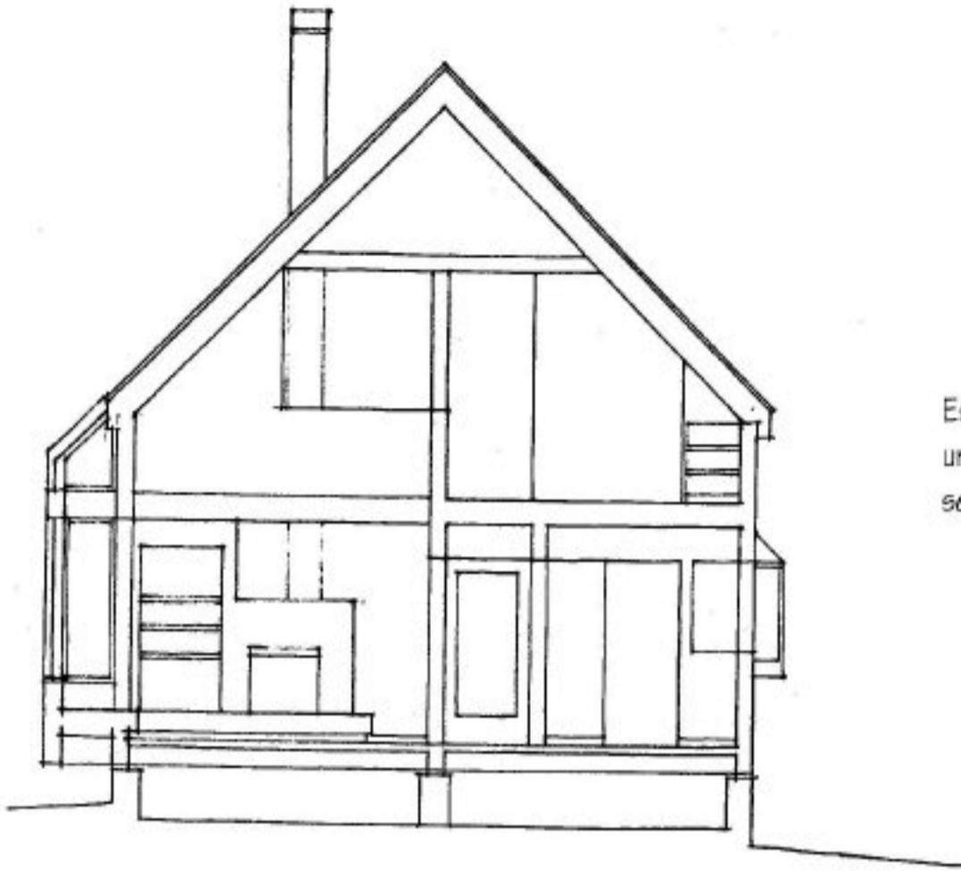
Este dibujo es una sección de un edificio grafiada con un valor de línea único. Resulta difícil distinguir lo que se ve en sección y en alzado.
