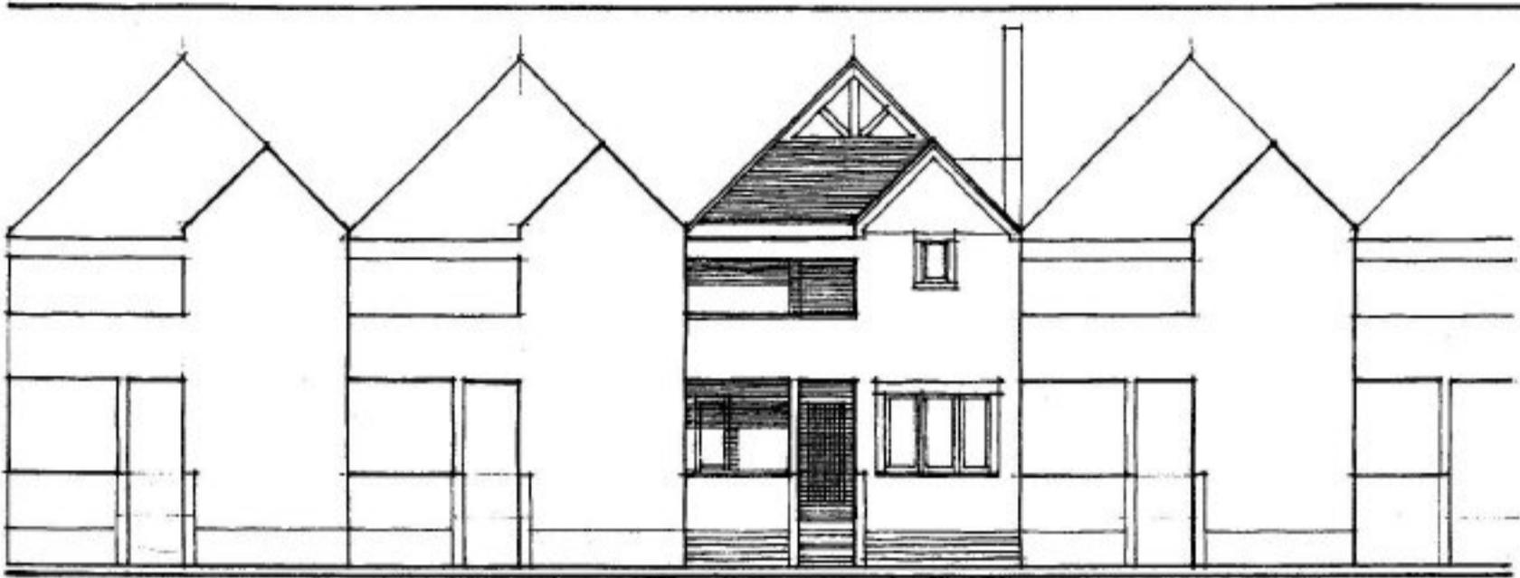
El alzado de un edificio puede entenderse como una sección del terreno trazada a cierta distancia de aquél. La separación entre el plano de corte y el edificio depende de qué elementos se desea mostrar delante del mismo y del grado con que interferirán en la visión total de la forma constructiva.
