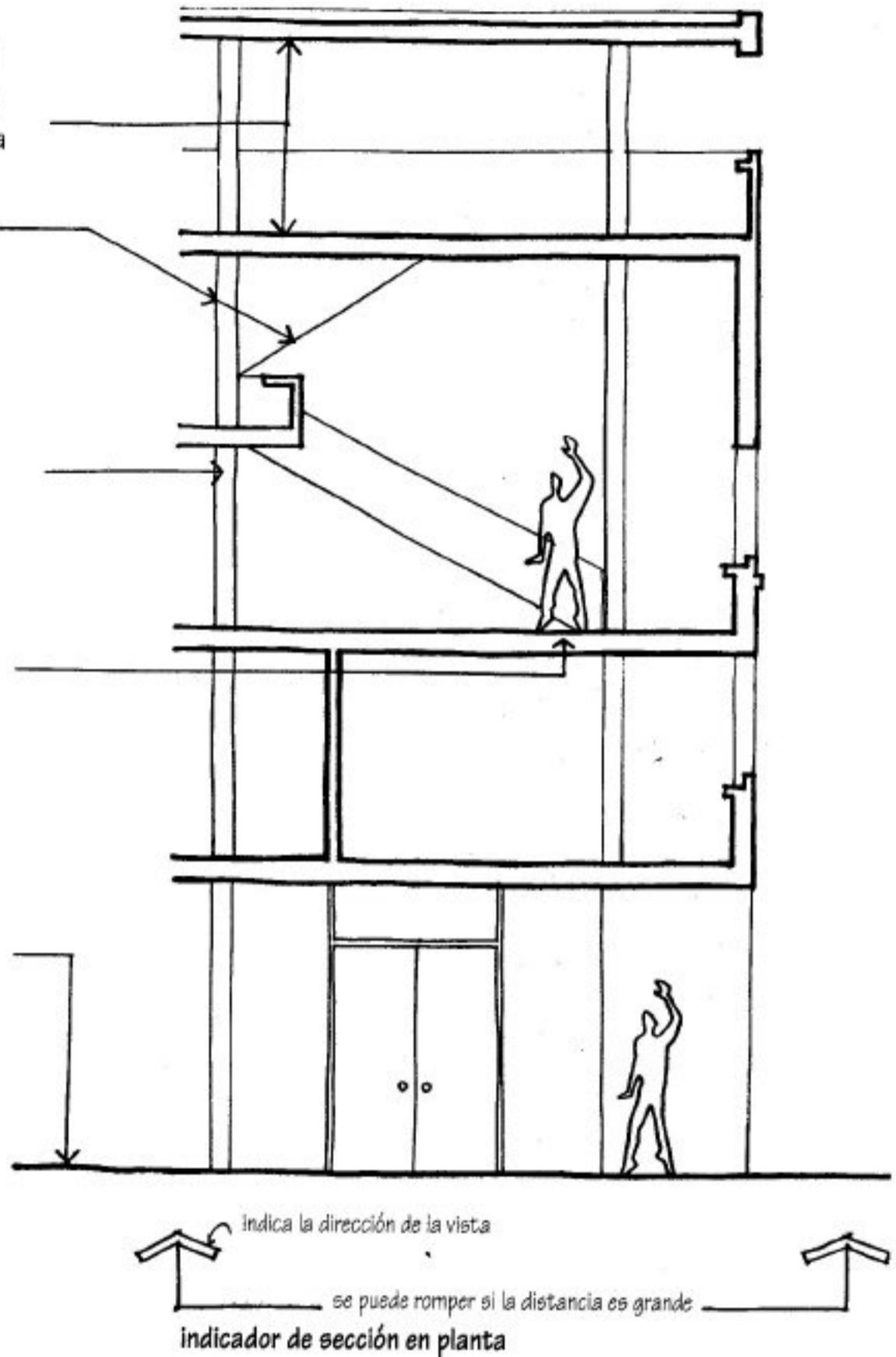
Las secciones de edificios se suelen dibujar a escala  $\frac{1}{8} = 10'$  o  $\frac{1}{4} = 10'$  (1:100 o 1:50). Para grandes edificios y complejos, la escala se puede reducir a  $\frac{1}{16} = 10'$  (1:200) o incluso menores. Para detalles constructivos se utilizan escalas mayores ( $\frac{3}{8} = 10'$  [1:20]).
