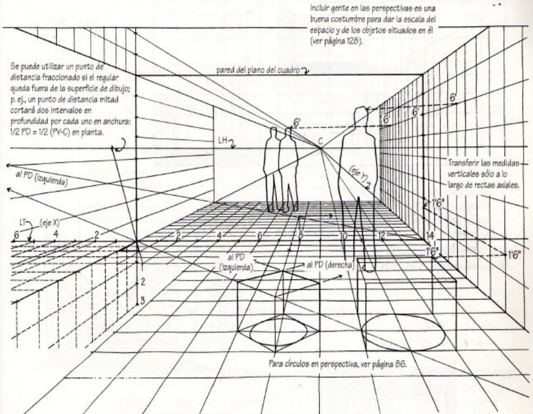
Nótese que la retícula se puede extender a derecha, izquierda, arriba y abajo con sólo prolongar los lados de la pared del plano del cuadro y la línea de tierra.
