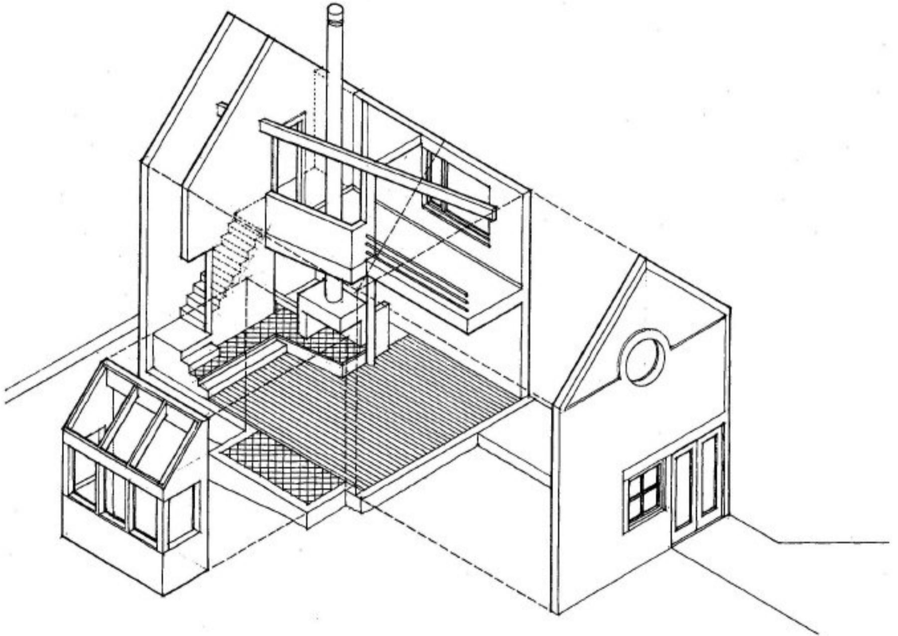
Los edificios compuestos por varias plantas que se repiten pueden mostrarse interiormente por la eliminación de sucesivas porciones que las dejan al descubierto a partir de la primera.
