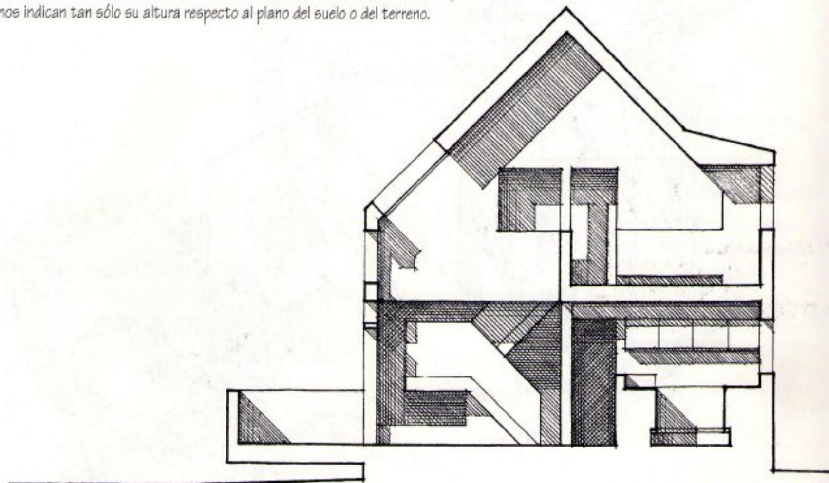
Los elementos que proyectan sombra en las secciones son las paredes, el suelo y la cubierta, además de aquellos objetos que sobresalen e invaden el espacio. La profundidad de las sombras arrojadas por los elementos seccionados dependen de la distancia que separa el plano de corte y el plano que las recibe.
