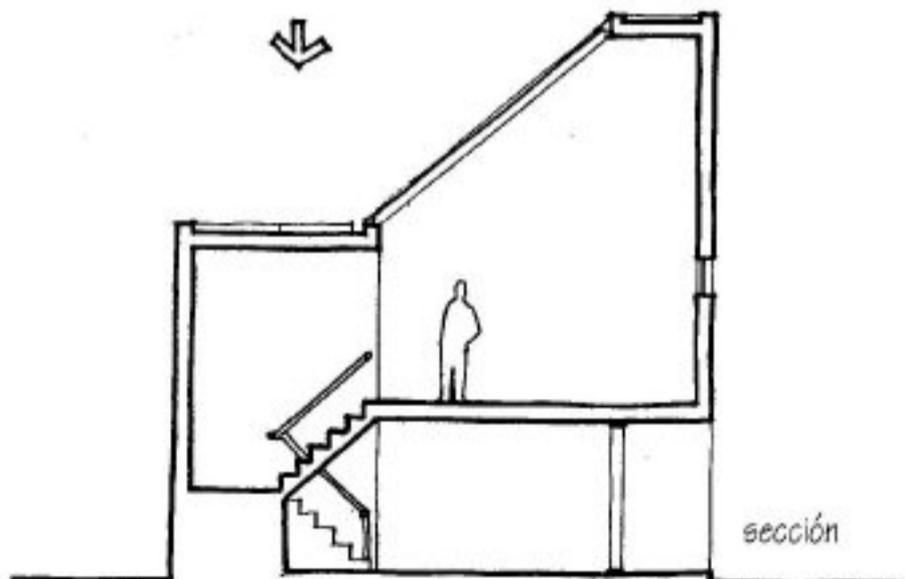
Como en las plantas, todo lo que queda cortado al hacer una sección (suelos, paredes, estructura de la cubierta, etc.) tiene que ir perfilado con una línea gruesa. Lo que queda más allá del plano de la sección se verá en alzado.
