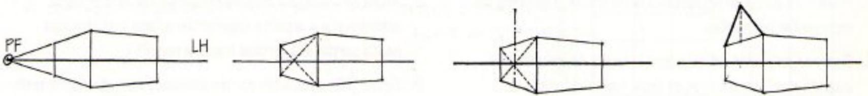
Por ejemplo, el remate de un hastial puede dibujarse en perspectiva fijando el centro del plano rectangular del muro por medio de las diagonales (véase pág. 83).
