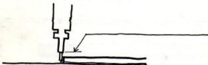
Hay que asegurarse de que la longitud del tubo de la punta de la pluma es superior al grosor de las escuadras y reglas que se usan.
