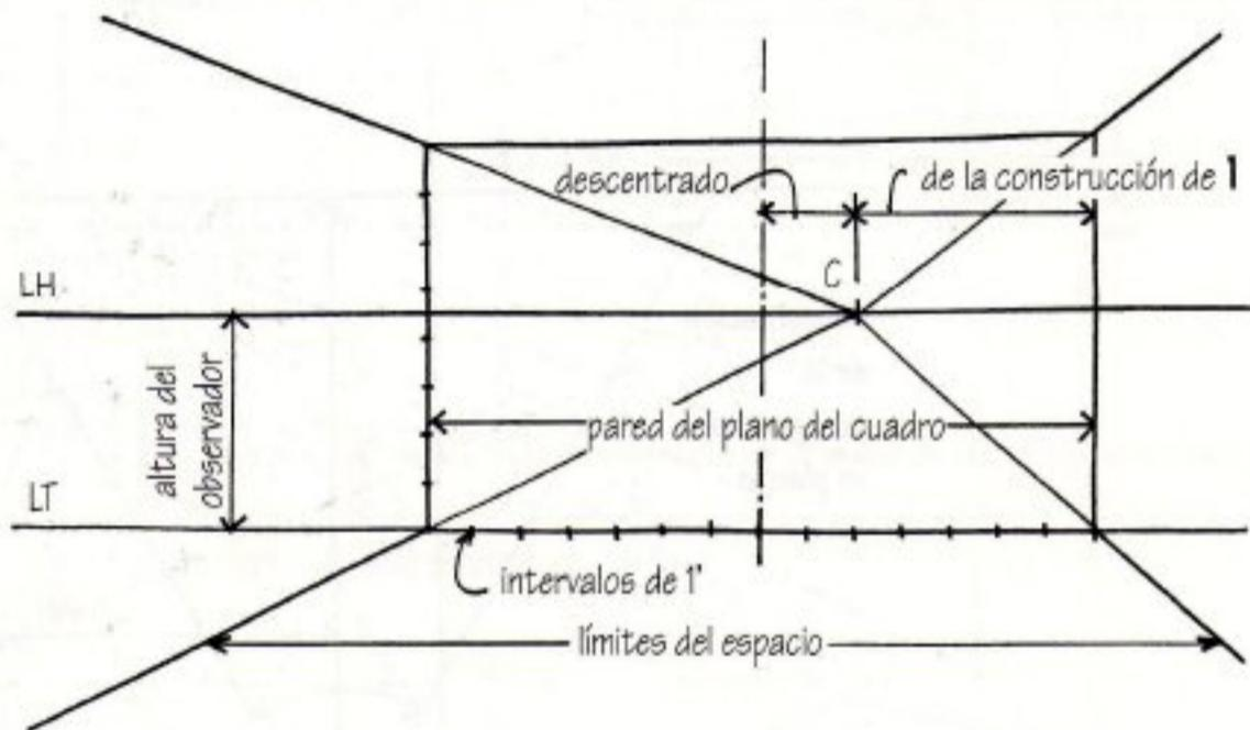
4. Situar el centro de visión (punto principal) del observador; su posición sobre el eje X viene determinada por la construcción en planta de **1**.
