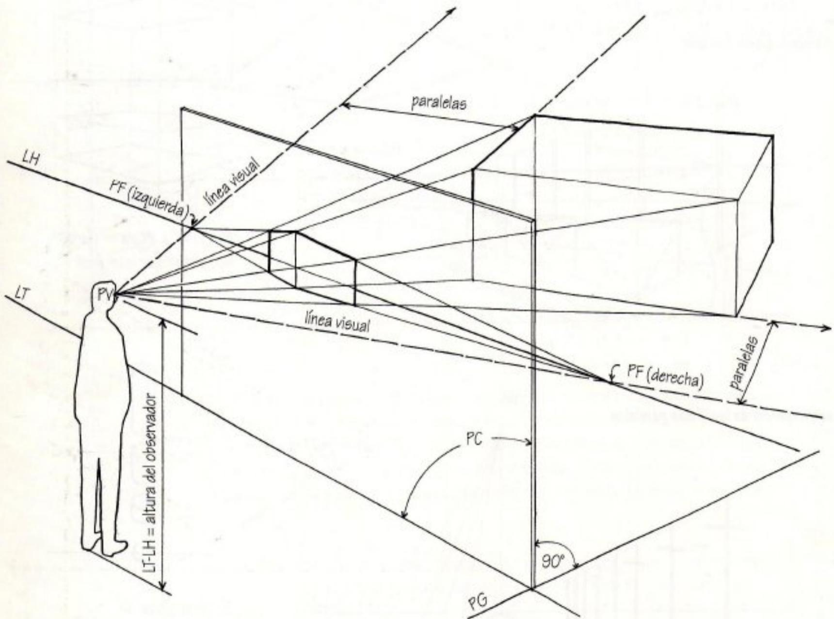
**Punto de vista (PV):** Da la posición y orientación del observador el efecto pictórico obtenido con una perspectiva viene determinado por la posición del PV, su distancia a lo que se mira y el ángulo visual.
