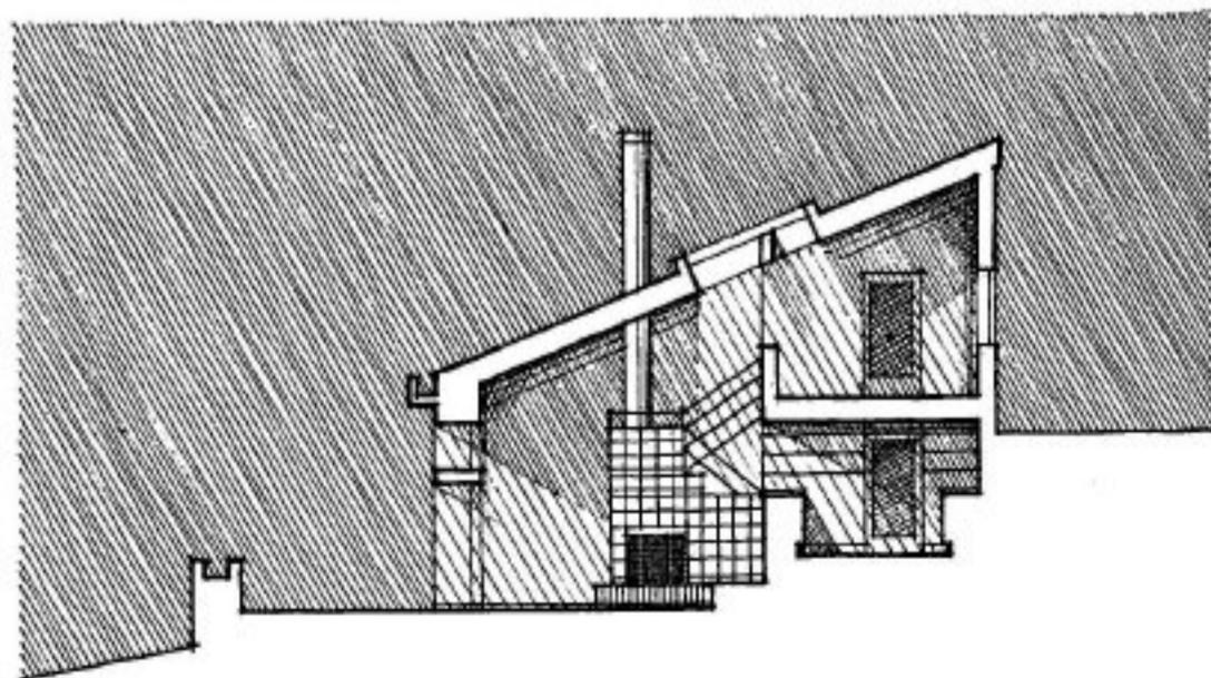
En estos alzados se hace nuevamente uso del contraste de valores tonales para situar algunos elementos por delante de otros. La profundidad en un alzado viene de ejecutar los materiales y las texturas de los elementos anteriores con más pormenor que la de los posteriores. Este sistema de valores admite su inversión de modo que los fondos sean más oscuros que los primeros planos.
