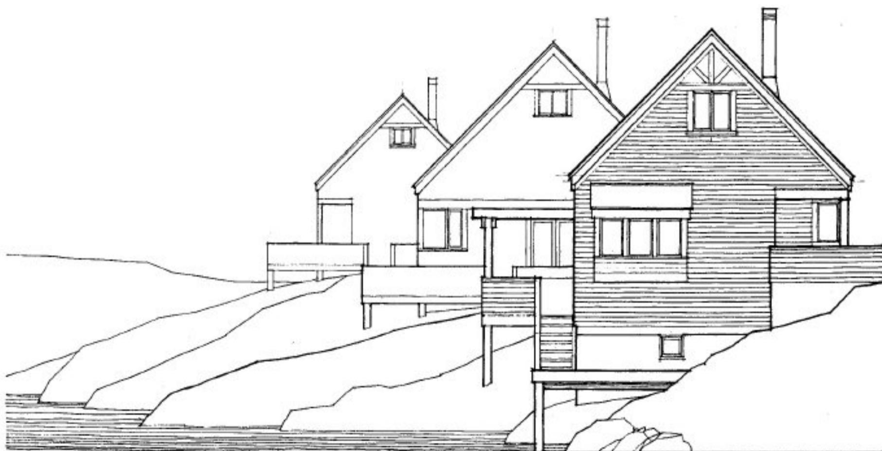
Las reglas de la proyección ortogonal no se siguen estrictamente al reducir la escala de los elementos en un alzado. Esta técnica requiere criterio y no debe utilizarse si causara confusiones.
