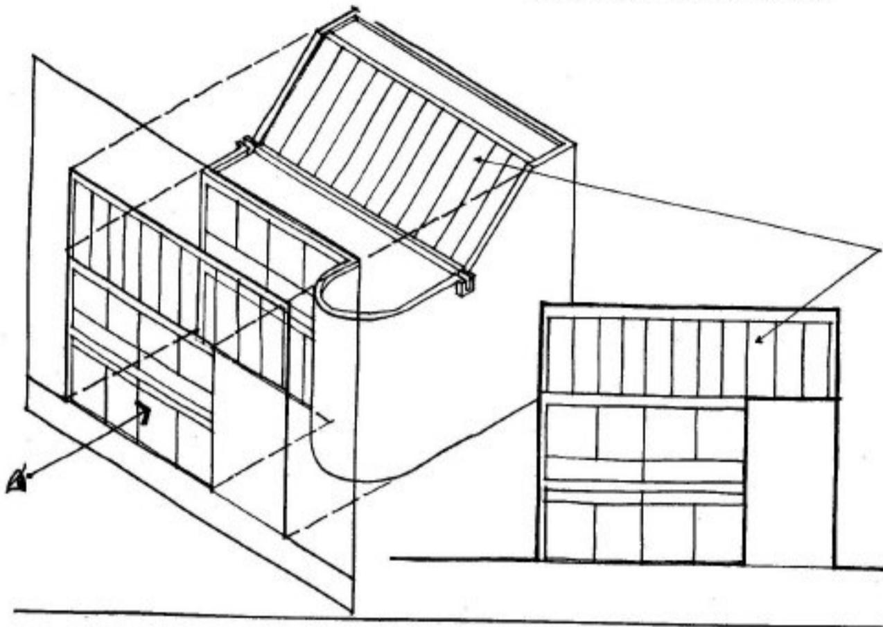
Todas las superficies planas no paralelas al plano de dibujo (no perpendiculares a la línea de vista del observador) aparecen en escorzo.
