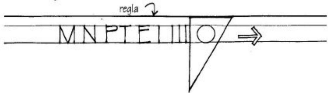
Una rotulación inclinada es direccional y generalmente distrae en un dibujo rectilíneo.
