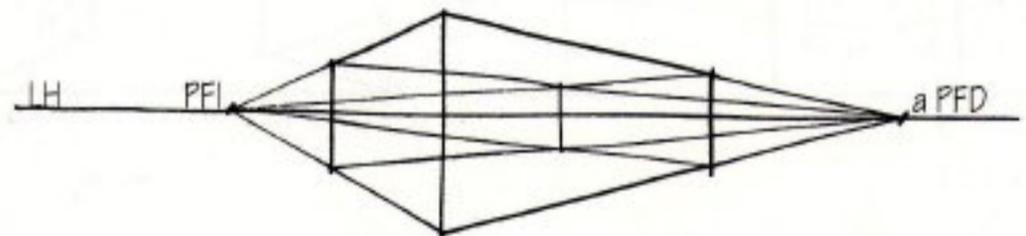
3. La perspectiva de tres fugas tiene los tres conjuntos principales de rectas (ejes X-Y-Z) oblicuos al plano del cuadro y en consecuencia tiene tres puntos de fuga principales.
