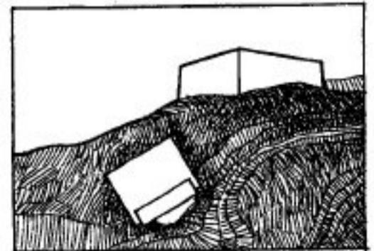
La aplicación de un valor tonal en el campo gráfico de un dibujo puede ayudar a definir otro dentro del primero. El fondo oscuro de un alzado puede fusionarse con la sección. El primer plano de una perspectiva puede convertirse en el campo de una planta del edificio.
