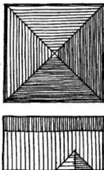
La **planta de la cubierta** es simplemente una vista mirando el edificio perpendicularmente hacia abajo, sin efectuar ningún corte. Sirve para representar la forma y el volumen de la cubierta dentro de los límites de un dibujo bidimensional.
