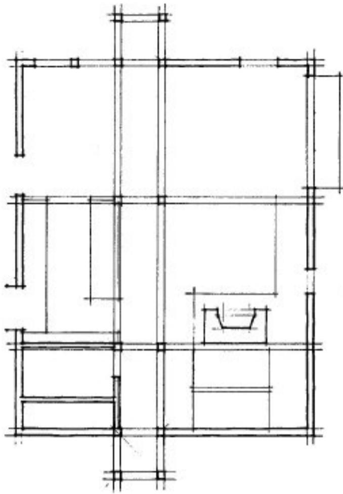
Acto seguido, se dibujan aquellos elementos destacados, como las ventanas, las puertas y las chimeneas, que son parte integrante de los anteriores.
