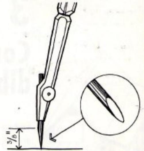
Para las minas de los compases se recomienda una punta biselada de  $3/8''$  (1 cm), para poder trazar unas líneas claras sin tener que presionar en exceso; una punta biselada se desgasta fácilmente y hay que afilarla a menudo.
