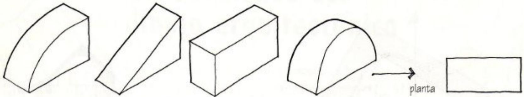
Aunque estos cuatro objetos tienen formas distintas, las **plantas** (mirando verticalmente hacia abajo) son **idénticas**. Por esta razón, la relación entre planta, sección y alzado es básica para la descripción y comprensión de lo que se está dibujando. Cuando utilizamos plantas, secciones y alzados para describir arquitectura, tenemos que ver estos dibujos como **una serie de vistas relacionadas**. Todas ellas contribuyen a todo lo que estamos dibujando.
