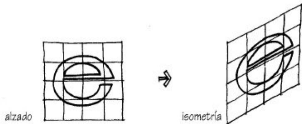
Para trazar líneas curvas de forma libre se pueden utilizar una retícula paralela al par de ejes apropiado y luego trazar la figura guiándose por los puntos de intersección hallados en el dibujo axonométrico.
