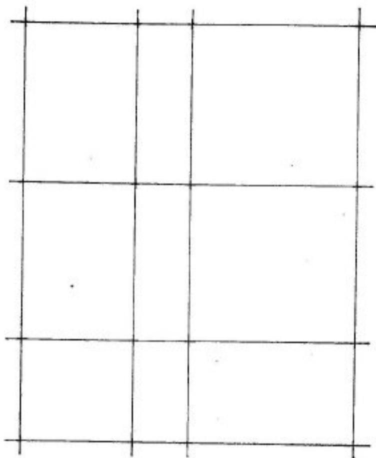
En primer lugar, se dibuja el contorno principal y las líneas que regulan la posición de las paredes y elementos estructurales.
