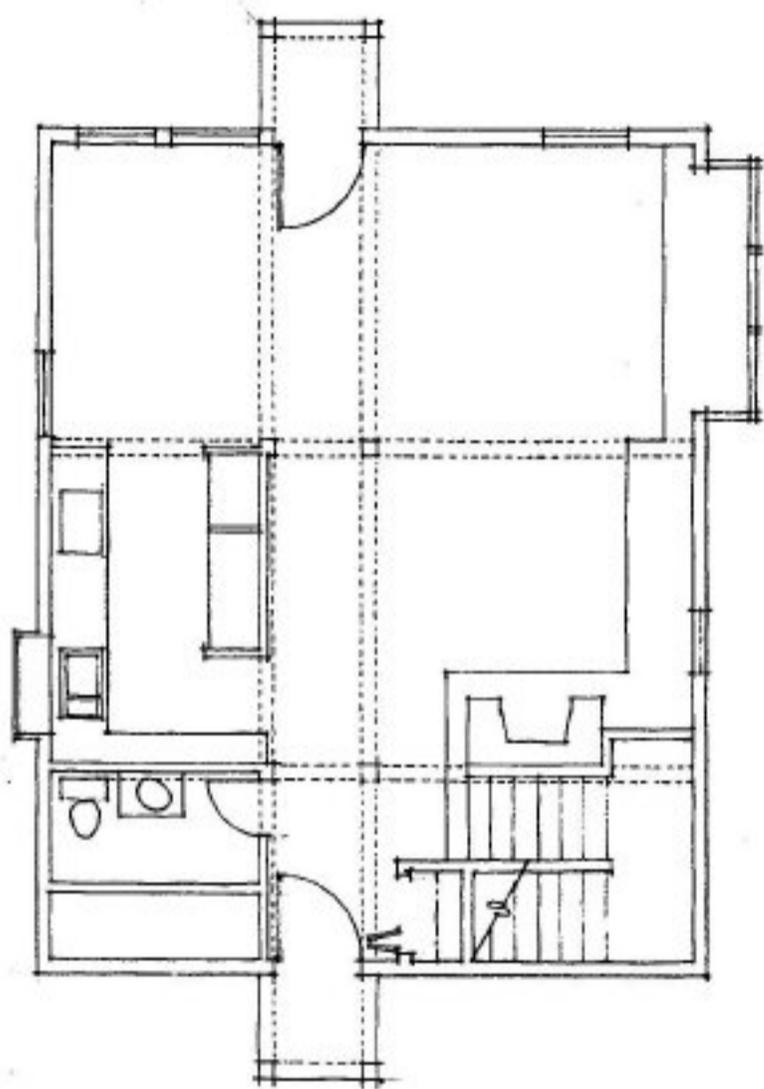
Este dibujo es una planta trazada con un valor de línea simple. En los que siguen entran ya diferentes valores de línea a fin de transmitir la sensación de profundidad. La línea más gruesa se emplea para contornear los elementos seccionados y, por tanto, más próximos al observador.
