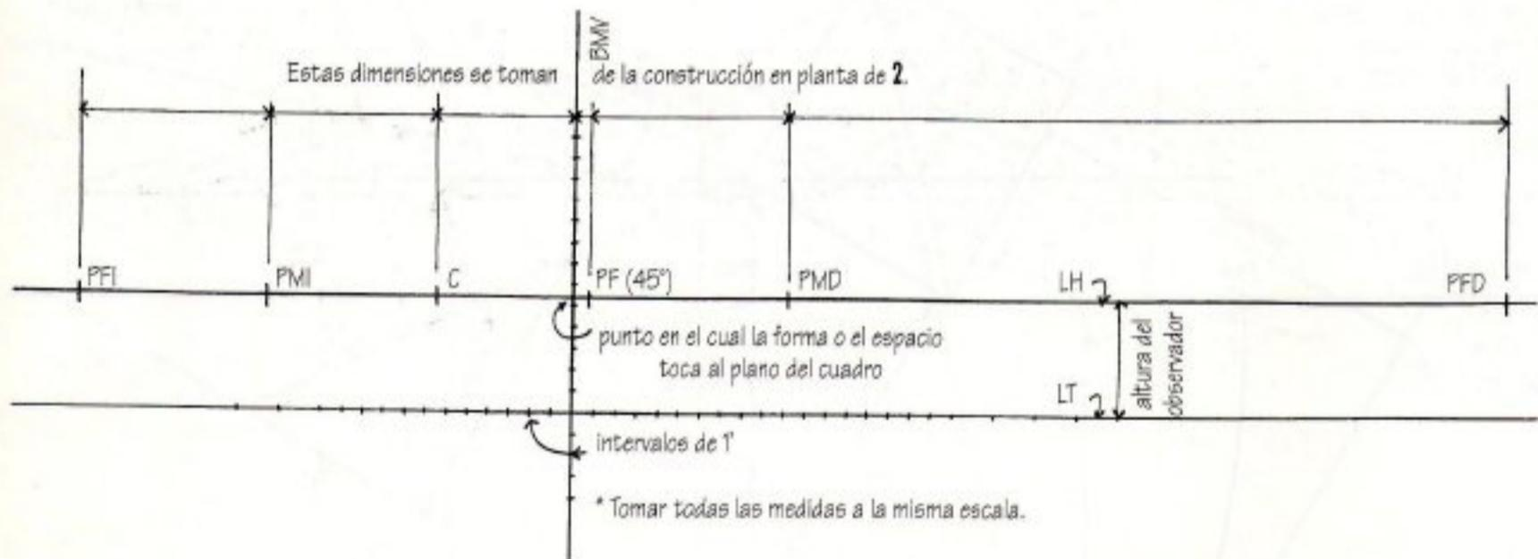
5. Trazar intervalos de 1' (30 cm) sobre la línea de tierra y sobre la línea base de medidas verticales.
