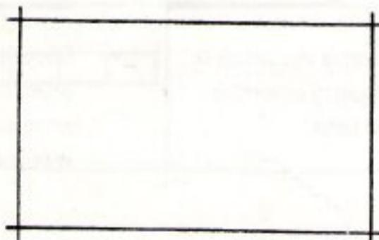
↖ Una intersección excesiva en las esquinas queda desproporcionada con el tamaño del dibujo.
