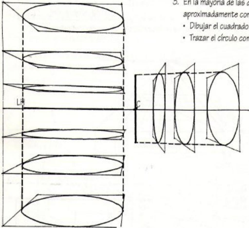
Nótese la diferencia entre el diámetro del círculo visto en perspectiva y el eje mayor de la elipse.
