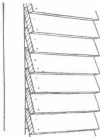
Fig. 74. ENTABLADO DE INTEMPERIE
