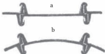
Fig. 187. TABLESTACAS METÁLICAS
