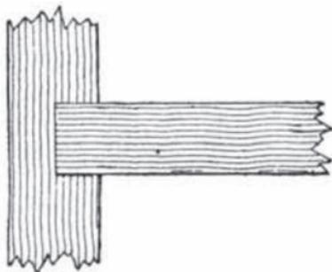
Fig. 146. ENSAMBLADURA DE PALMA
