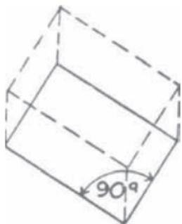
Fig. 163. PROYECCIÓN AXONOMÉTRICA
