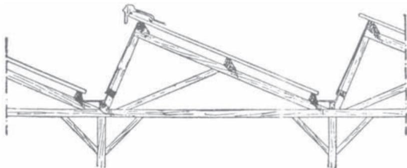
Fig. 68. CUBIERTA EN DIENTE DE SIERRA O SHED
