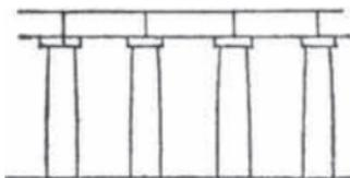
Fig. 5. CONSTRUCCIÓN ADINTELADA
