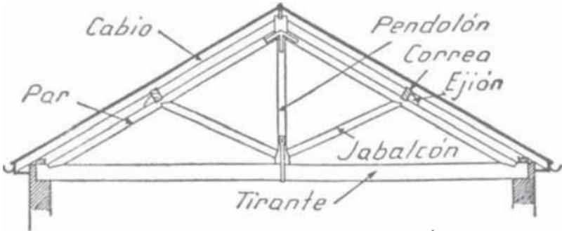
ARMADURA DE CUBIERTA CON PENDOLÓN
