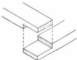
Fig. 128. ENSAMBLE A MEDIA MADERA
