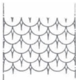
Fig. 81. ESCAMAS DE ZINC PARA CUBIERTAS
