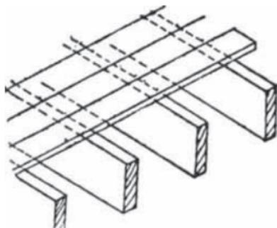
Fig. 208. VIGUERAS DE SUELO DE MADERA
