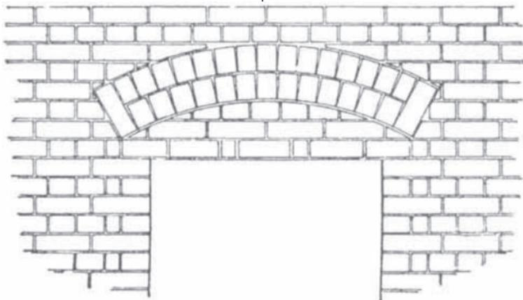
Fig. 22. ARCO DE DESCARGA
