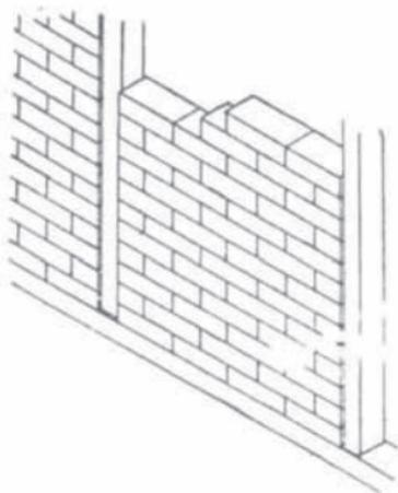
fig. 94. FORJADO DE LADRILLO
