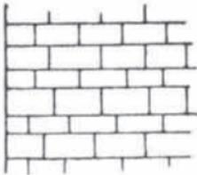
Fig. 183. FÁBRICA DE SILLERÍA
