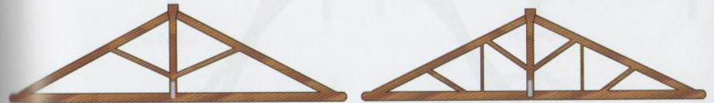
**De par y nudillo o de par y puente.** La de parhilera cuando incluye vigas horizontales (*nudillos*) para evitar la inflexión o pandeo de los pares. Fue usada por Palladio sin la péndola y sus extensiones (*tornapunta* y *cuchillero*). Existe la variante *de puente y sotapar*.
