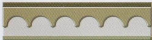
**Baquetones en zig-zag.** Moldura larga y estrecha, con estructura de línea quebrada en relieve, que imita la forma de los baquetones.
