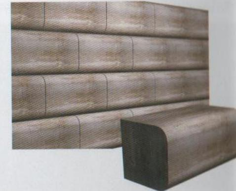
**De gola.** El que tiene las aristas labradas en gola. Suele aparecer integrado en otros almohadillados para destacar una zona importante o la clave de un arco que generalmente está rematada con moldura.
