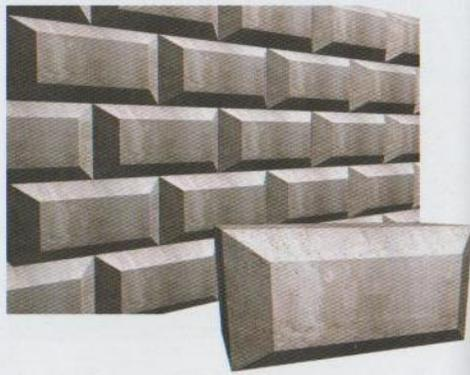
En **punta de diamante**. El que tiene la cara del sillar tallado en forma piramidal.
