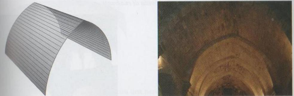
**De cañón o medio cañón peraltada.** Bóveda semicilíndrica cuya generatriz es un arco peraltado a través de un eje longitudinal (directriz recta). Bails la define como aquella cuya flecha o distancia entre arranque y clave es mayor que la mitad de la distancia entre los estribos o apoyos.
