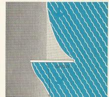
DEPOSITION AND EROSION FROM GROINS
