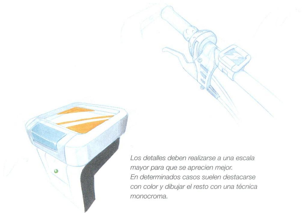
*Los detalles deben realizarse a una escala mayor para que se aprecien mejor. En determinados casos suelen destacarse con color y dibujar el resto con una técnica monocroma.*
